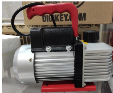
Ilustración 52. Bomba de vacío QE Quality QVP-180
