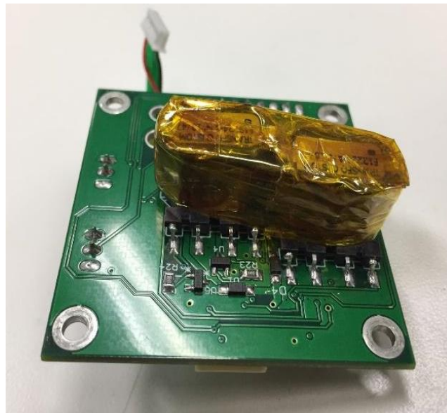
Ilustración 51. Controlador del motor con cinta Kapton
