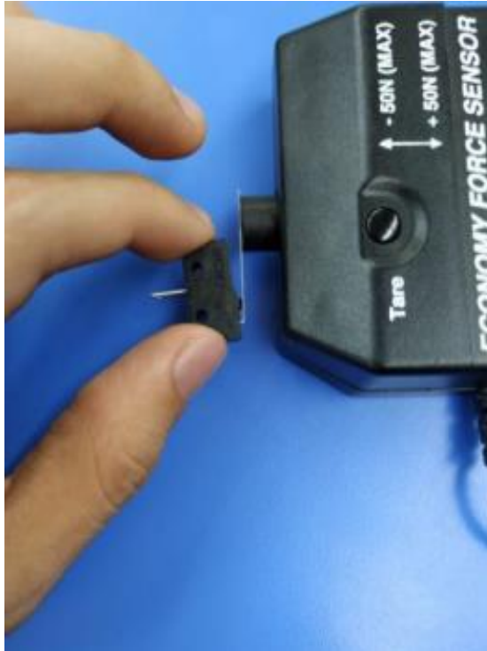
Ilustración 56. Montaje de prueba de fuerza interruptores de despliegue.
