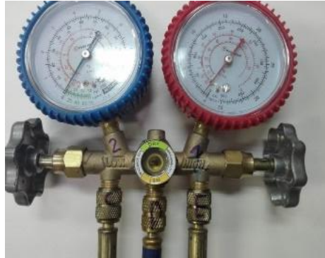
Ilustración 55. Manómetros de refrigeración
