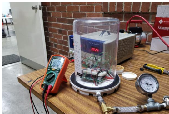
Ilustración 141. Prueba de placa ADCS en vacío.
