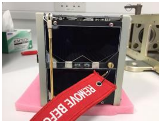
Ilustración 161. Superficie +X del CubeSat después de la prueba de termo-vacío
