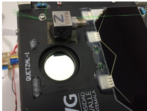
Ilustración 164. Filtro óptico después de la prueba de vibración
