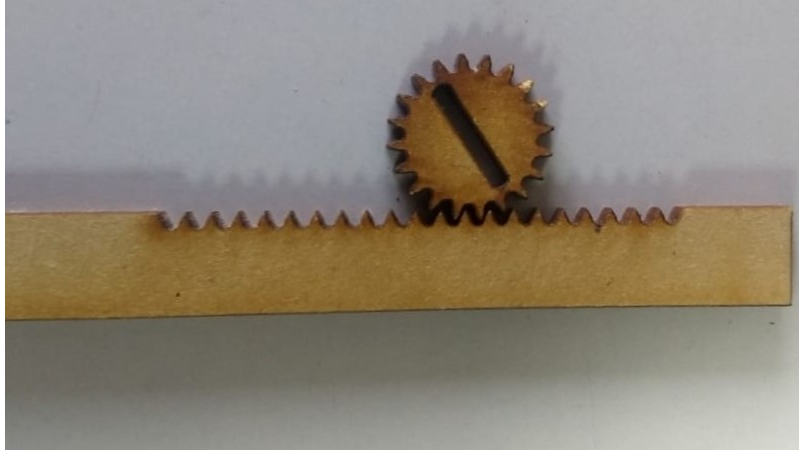
Figura 34: Implementación de piñón-cremallera en MDF de 3.2 mm
