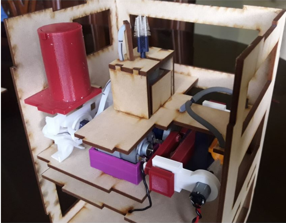
Figura 63: Sistema de aspersión ensamblado en la versión final del dispositivo de limpieza
