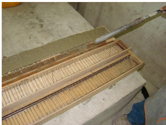
Figura 64. Vibrado de contacto para el modelo.
