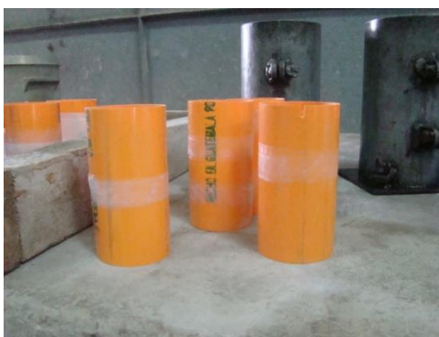
Figura 51. Moldes hechizos para los pequeños cilindros de concreto.
