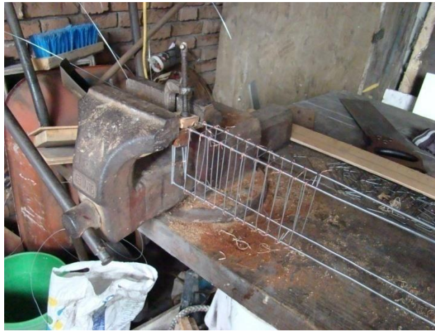
Figura 60. Estribos utilizados como refuerzo de corte.
