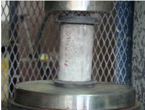
Figura 52. Pruebas realizadas a los cilindros de concreto.
