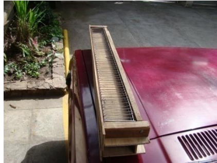
Figura 54. Vista panorámica de la formaleta utilizada para el modelo.
