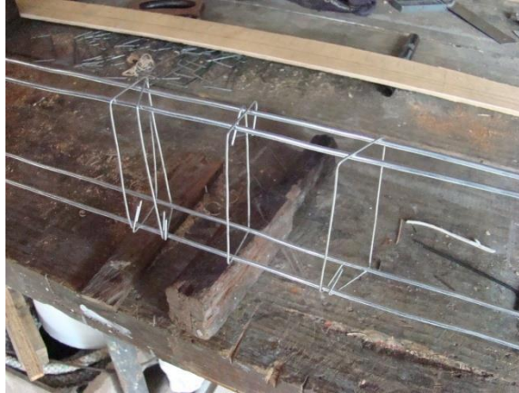
Figura 61. Estribos utilizados como refuerzo de corte.
