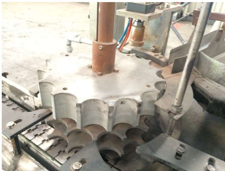
Ilustración 23 Estación de sellado de aerosoles
