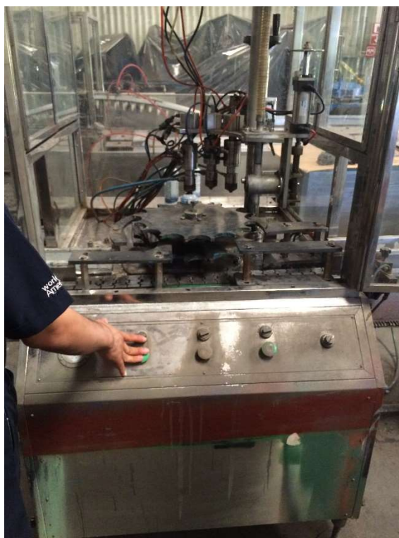
Ilustración 27 Limpieza y calibración de la estación de llenado de pintura
