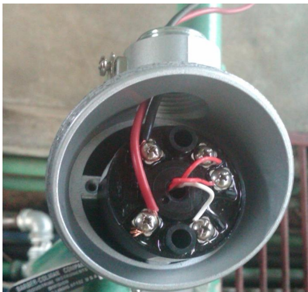
Ilustración 60. Transmisor de un RTD de 3 hilos implementado.
