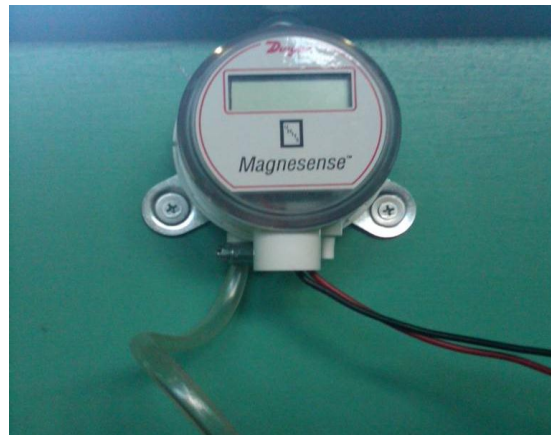
Ilustración 64. Transmisor de presión utilizado para la medición de presión del aire
