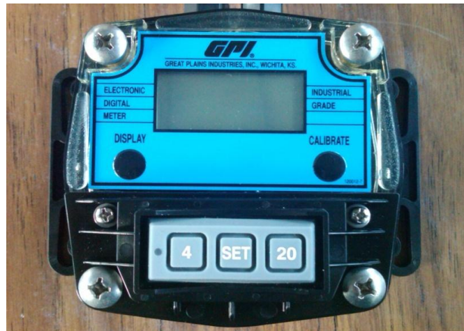
Ilustración 62. Transmisor del rotámetro usado
