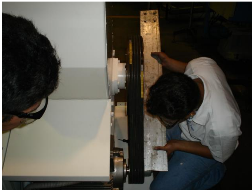
Figura 11. Mal procedimiento para verificar alineación de fajas.
