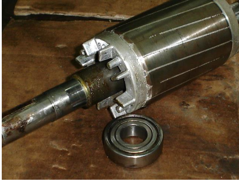
Figura 8. Cambio de cojinetes y limpieza de rotor.
