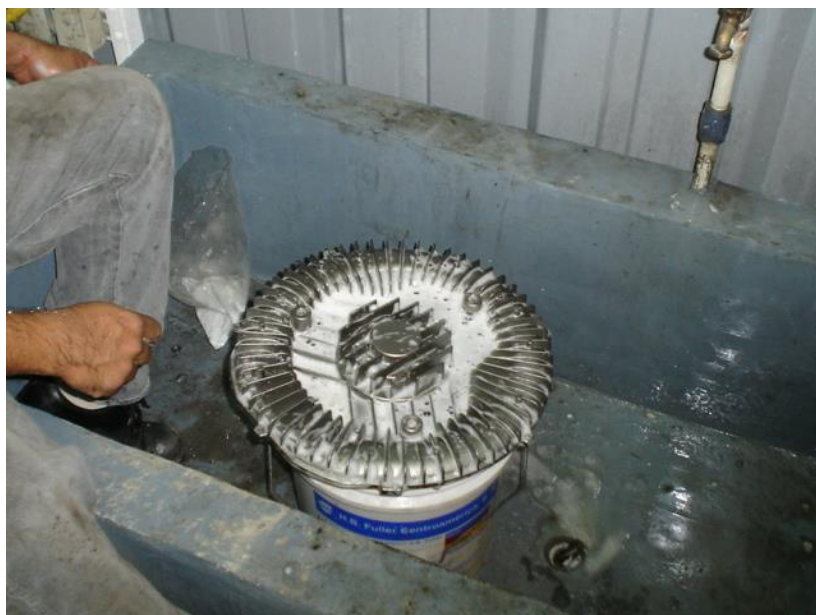
Anexo 3. Limpieza de estructura externa de turbina.
