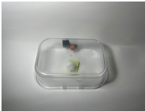
Figura 9: Posicionamiento de los sensores de alcohol y el algodón con las concentraciones de alcohol 35 % y 70 % respectivamente
