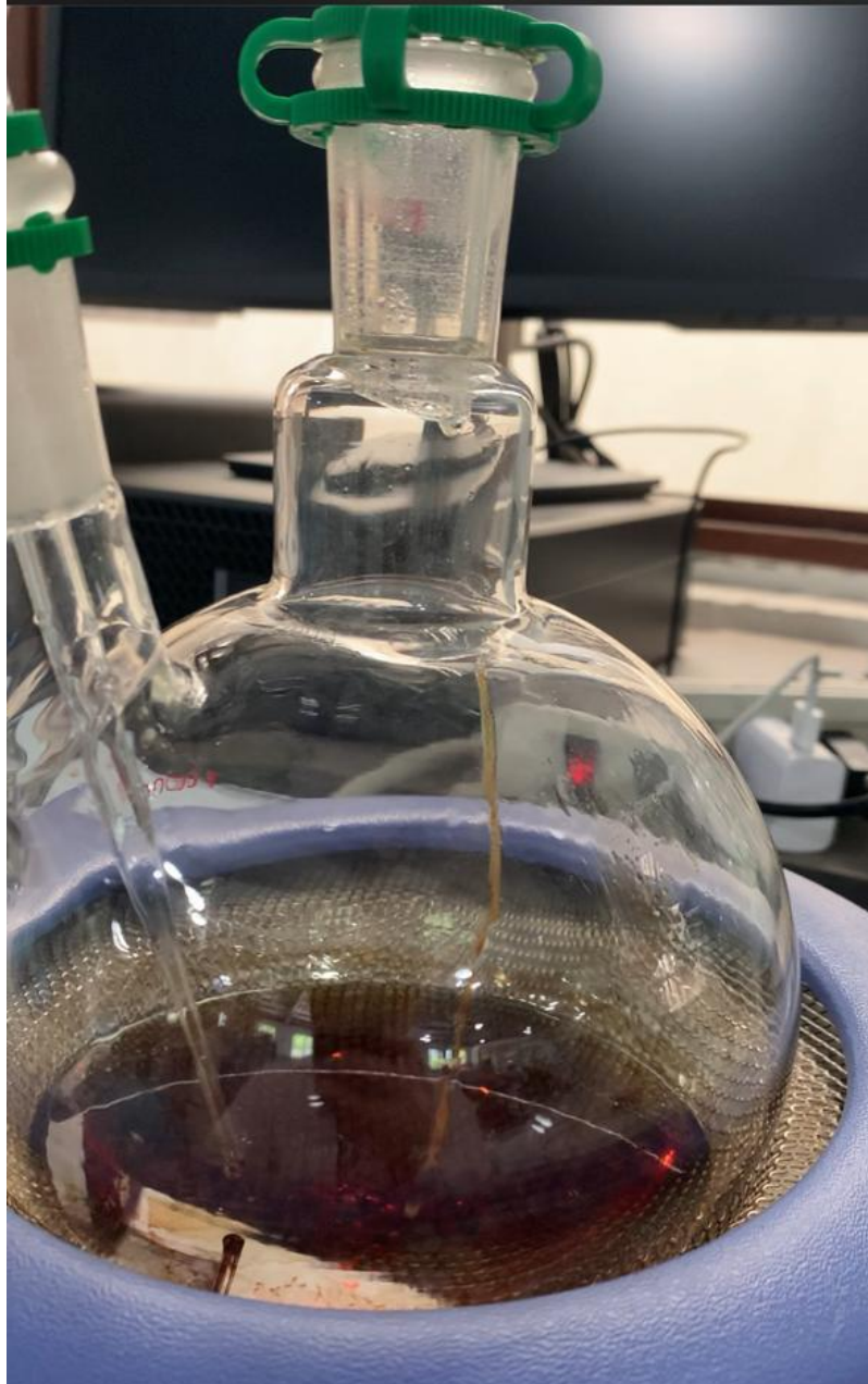
Figura 38. Balón de alimentación y tubo ebullidor importante en la regulación de la succión en un sistema de destilación al vacío para la producción de bioqueroseno obtenido de diferentes tipos de aceite
