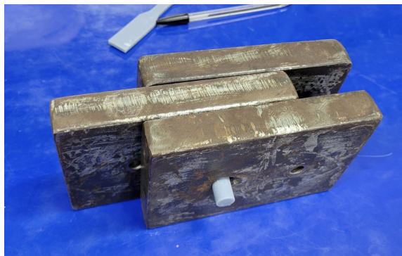
Figura 12. Configuración de accesorio para ensayo de corte
