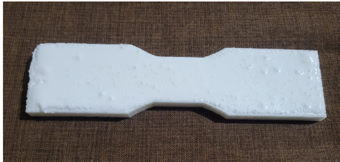
Figura 23. Visualización efecto de la humedad en colada de resina de uretano
