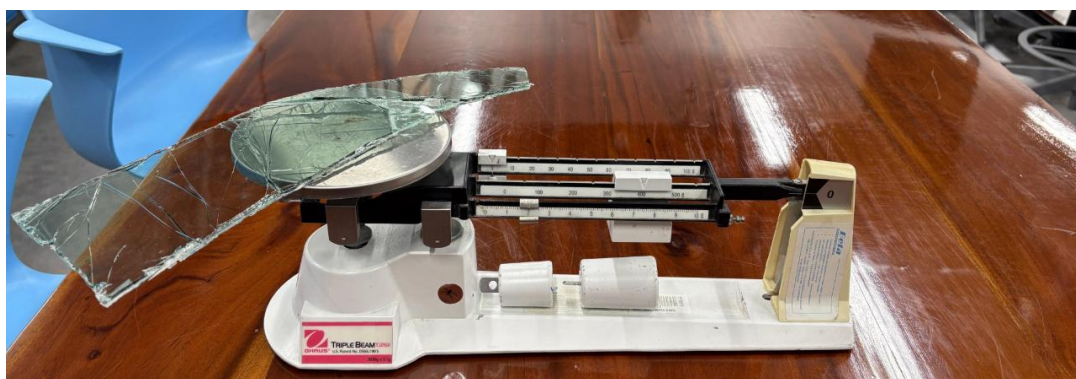
Figura 19. Medición del peso del vidrio antes de ser triturado
