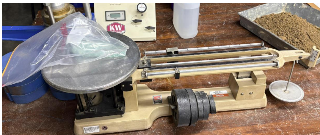
Figura 20. Medición del cullet desprendido de la película de PVB
