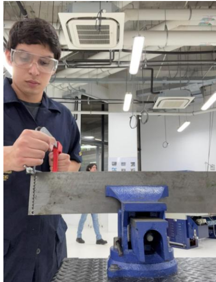
Figura 16. Corte de la platina hecho con segueta
