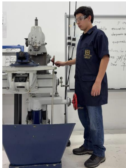
Figura 17. Maquinado de la platina con fresadora vertical
