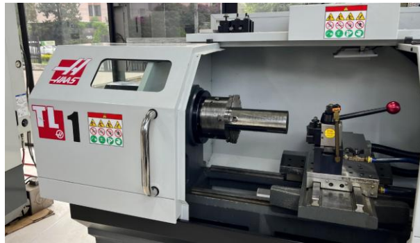
Figura 14. Montaje de barra circular en torno CNC Haas TL-1
