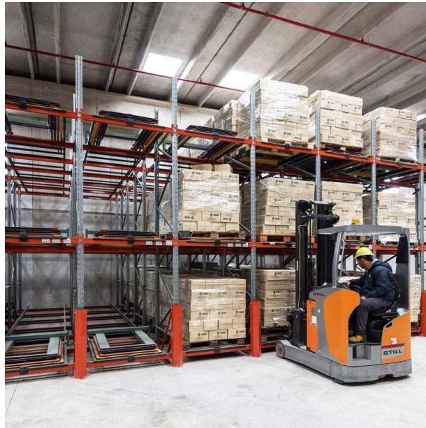
Figura 20. Aplicación del sistema push-back en instalaciones reales
