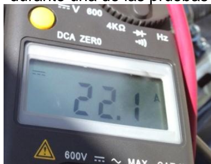
Figura 71: Lectura de una medición de corriente durante una de las pruebas
