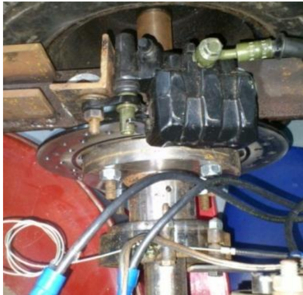
Figura 52: Frenos de disco y banda instalados
