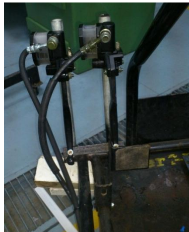
Figura 42: Bombas de freno sincronizadas
