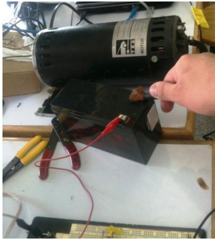
Figura 170: Sistema empleado para probar el sensor de corriente
