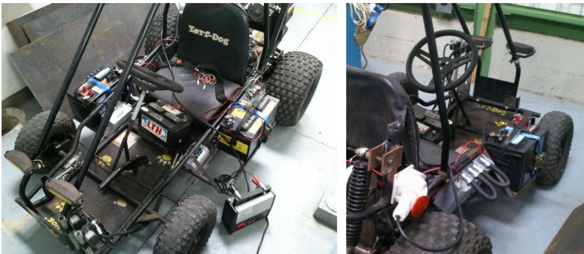
Figura 89: Posicionamiento de las baterías
