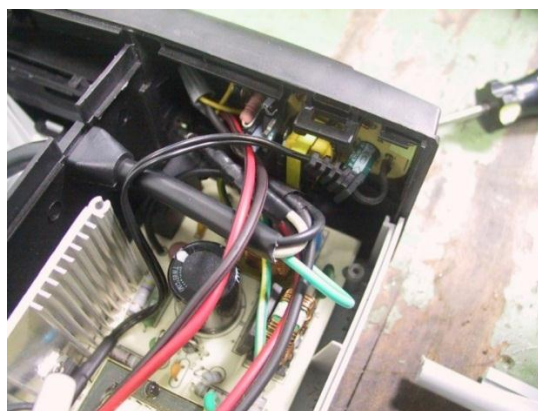
Figura 106: Adaptador de 12V instalado dentro del cargador automático.
