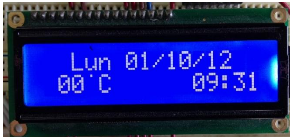
Figura 223: Pantalla LCD desplegando hora y fecha leído del RTC
