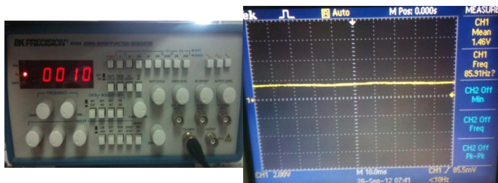
Figura 179: Simulación de velocidad baja para el sensor
