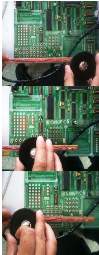
Figura 158: Pruebas de respuesta del interruptor de lámina
