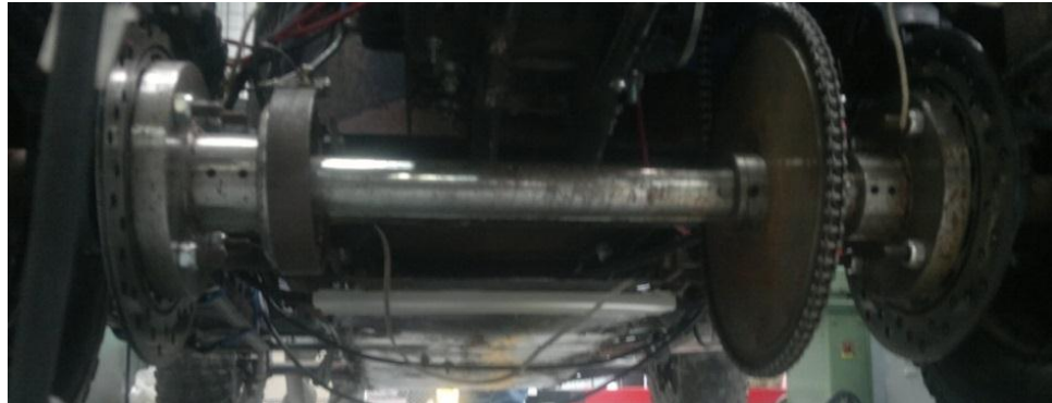
Figura 22: Sprockets del sistema de transmisión
