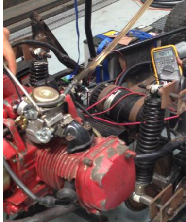
Figura 121: Ajuste de la válvula de mariposa del carburador
