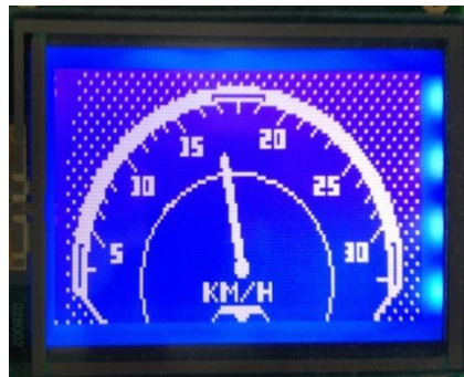
Figura 232: Velocímetro con un valor entrante del módulo de sensores de 17 km/h
