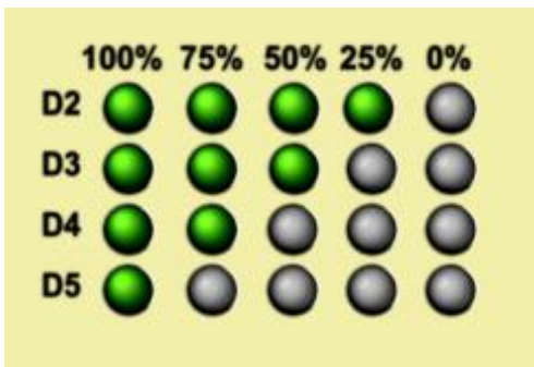
Figura 134: Diagrama de los niveles de combustible [92]
