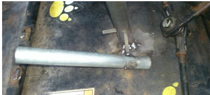
Figura 48: Prototipo de palanca de freno de mano
