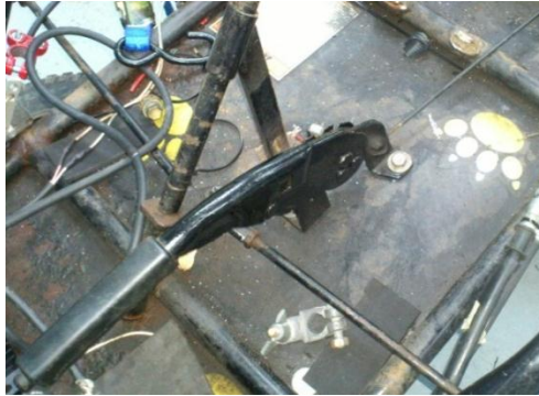
Figura 49: Instalación final de la palanca de freno de mano
