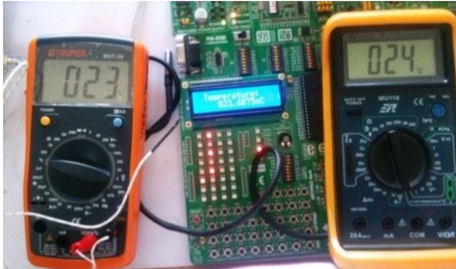
Figura 154: Lectura de temperatura ambiente con tres dispositivos distintos
