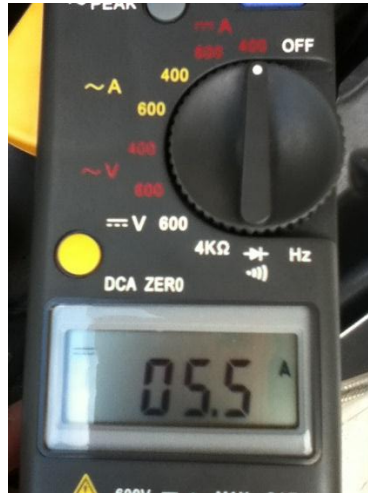
Figura 114: Corriente del alternador a baterías.
