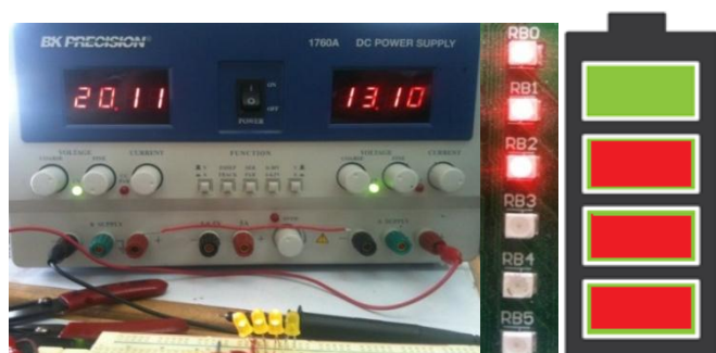
Figura 192: Representación de nivel de batería medio-alto
