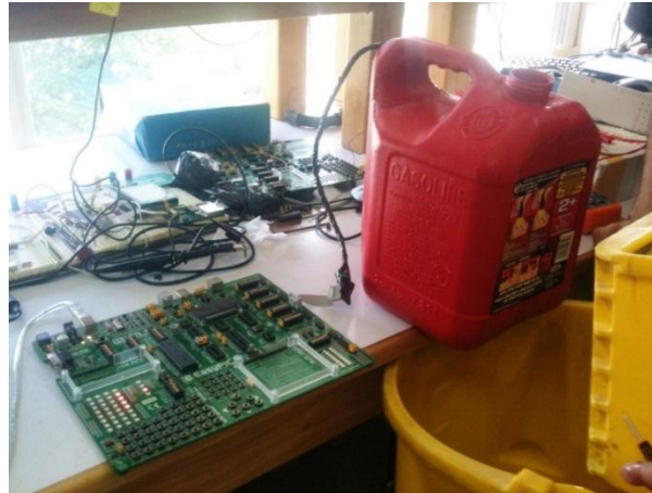
Figura 159: Sistema empleado para probar el sensor de nivel de combustible
