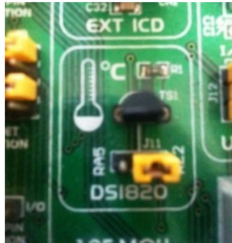
Figura 151: Módulo de conexión del sensor DS18B20 en el EasyPic6
