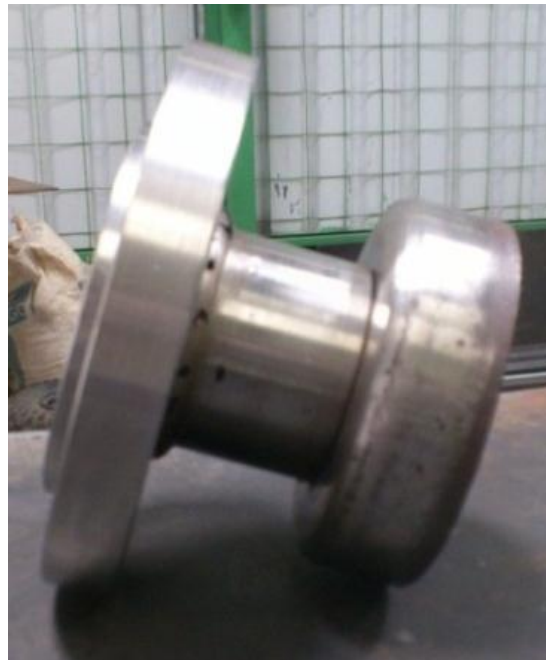
Figura 47: Tambor del freno de banda colocado en la masa
