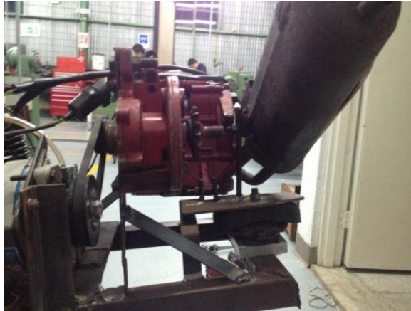
Figura 129: Estructura de soporte para el motor, vista lateral
