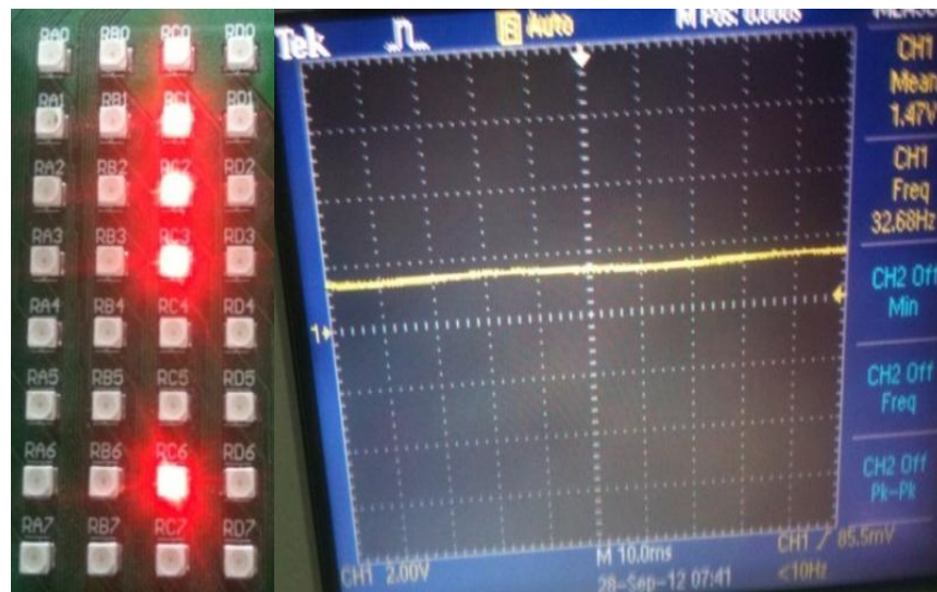
Figura 184: Lectura de la velocidad alimentando el motor DC con 12V
