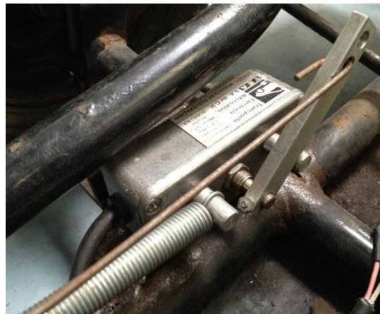
Figura 79: Posición correcta del resorte y varilla del acelerador
