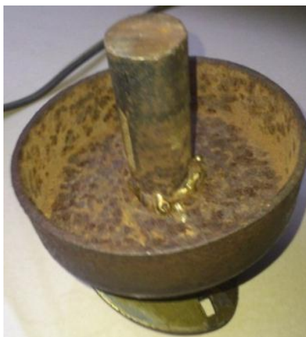
Figura 45: Tambor colocado en el eje antiguo
