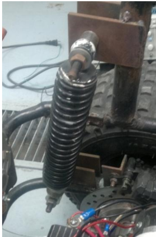
Figura 25: Sistema resorte-amortiguador instalado en el vehículo
