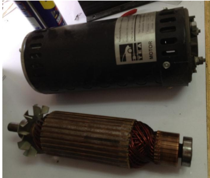
Figura 54: Motor eléctrico de la transmisión
