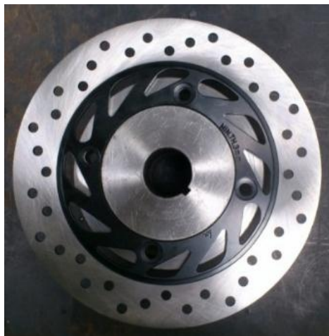
Figura 40: Vista en planta de masa con disco de freno
