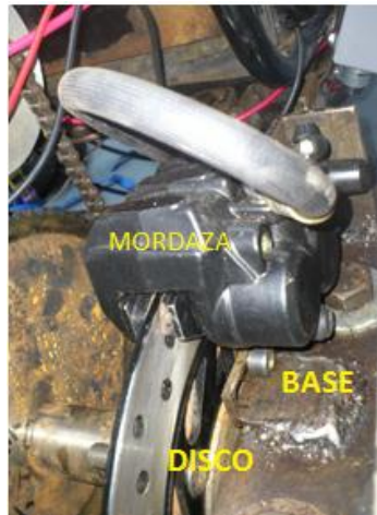
Figura 44: Instalación final de mordaza con los soportes visibles.
