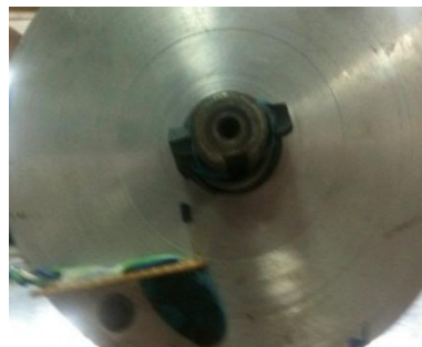
Figura 182: Posicionamiento del sensor A3144
