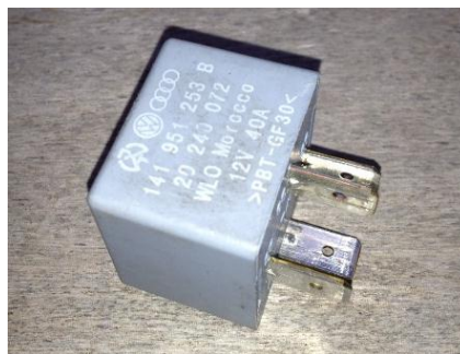
Figura 66: Relé utilizado para activar el “starter”
