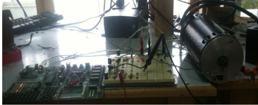
Figura 180: Sistema empleado para pruebas de velocidad
