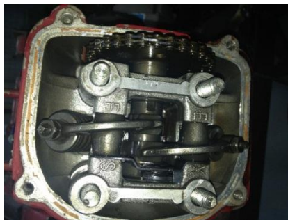
Figura 115: Estado interno del motor de combustión interna
