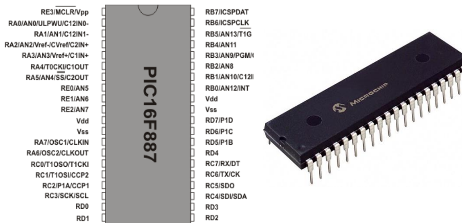
Figura 146: Diagrama del PIC16F887 [66]
