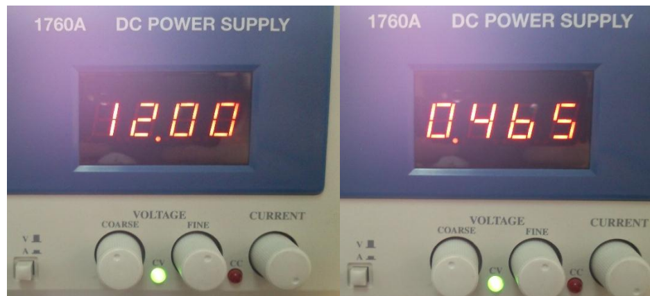
Figura 91: Voltaje (izquierda) y corriente (derecha) utilizados por los tres relés.
