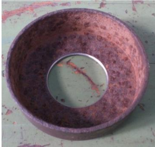
Figura 46: Freno removido del eje con oxidación
