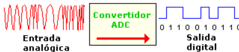
Figura 148: Funcionamiento de un Convertidor ADC [96]
