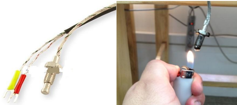
Figura 130: Pruebas con termocupla tipo K [108]
