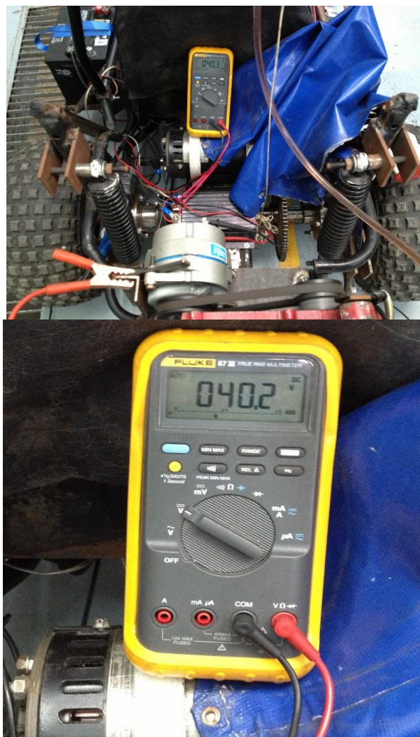
Figura 113: Voltaje producido por el alternador sin carga.
