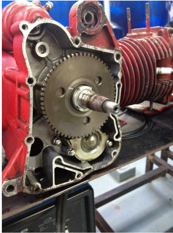
Figura 116: Estado interno del motor de combustión interna
