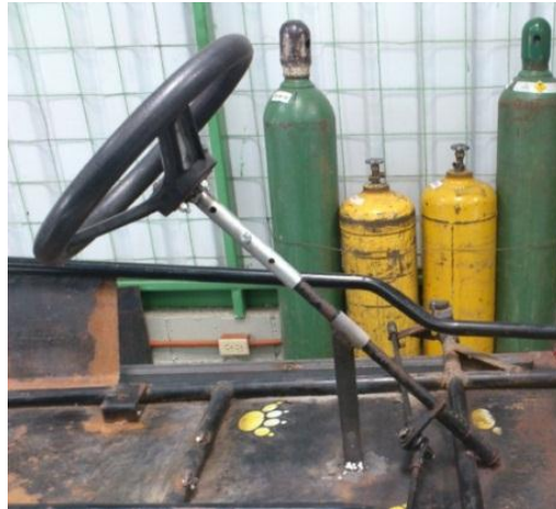
Figura 36: Timón con barra ajustable
