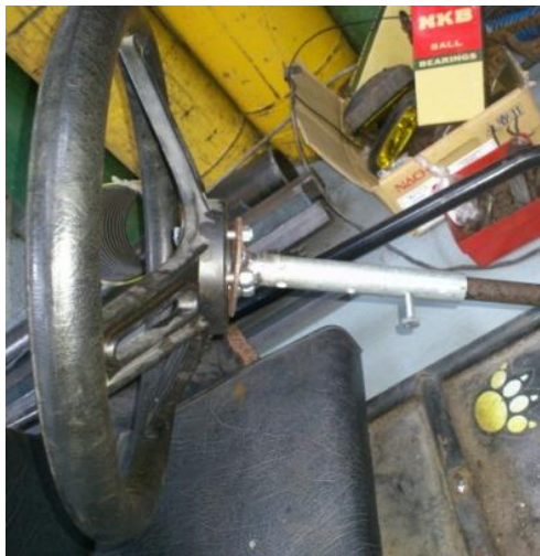
Figura 37: Timón con barra que tiene tres agujeros para diferentes distancias
