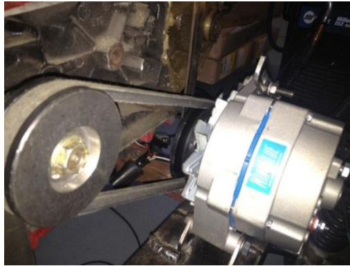
Figura 119: Vista en perfil: Sistema de transmisión de potencia instalada
