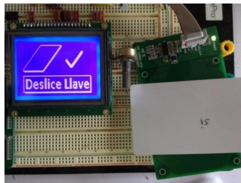
Figura 227: Pantalla GLCD representando llave válida
