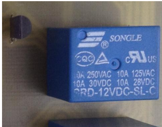
Figura 63: Relé de activación y desactivación del motor de combustión interna
