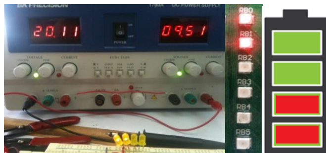
Figura 191: Representación de nivel de batería medio-bajo
