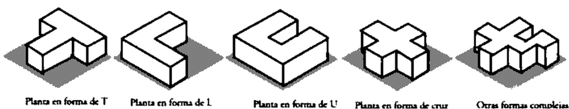
Figura No. 5 Algunas configuraciones irregulares en planta.
