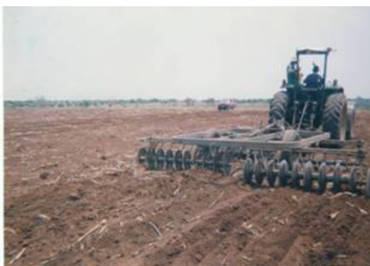
Figura 12: rastra fitosanitaria para control de huevecillos de chinche salivosa.
