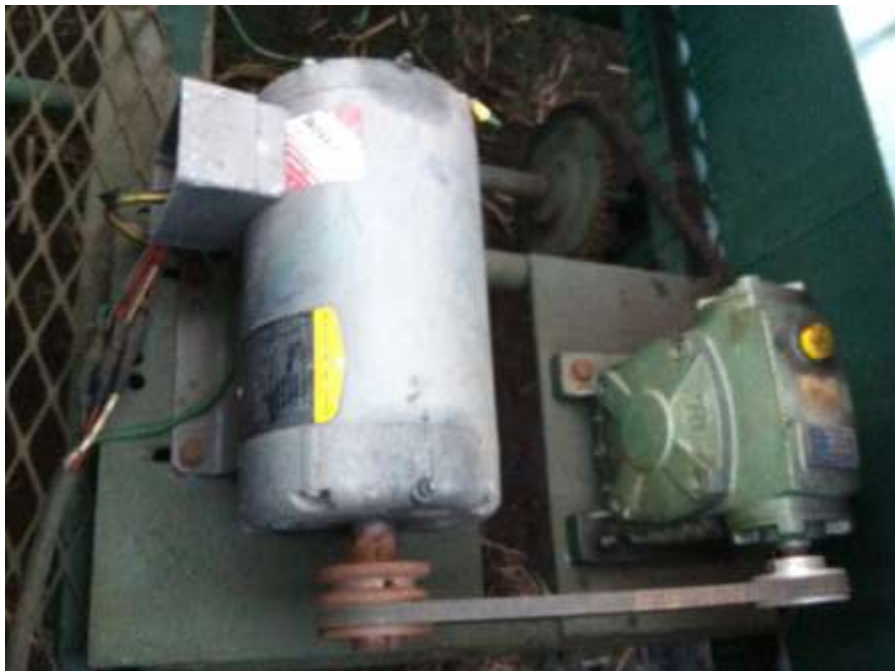
Figura 16. Mecanismo de movilidad del carretón
