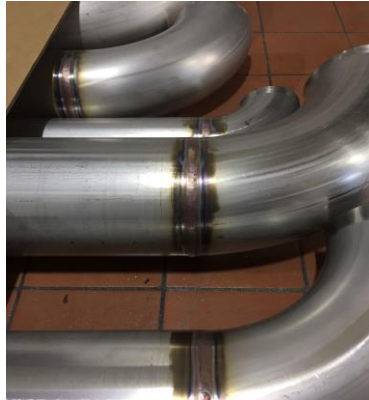
Figura 15. Soldadura TIG en tuberías de acero inoxidable 304
