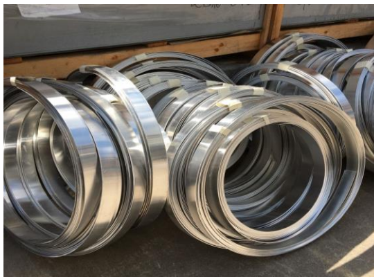
Figura 45. Vigas espaciadoras de acero inoxidable 304 roladas
