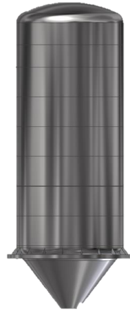
Figura 37. Ensamble de ocho anillos de acero inoxidable
