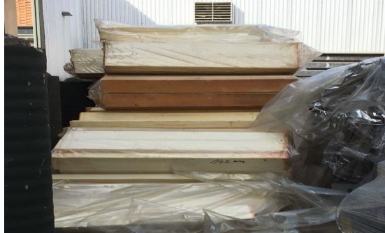
Figura 43. Vigas de espuma separadora de 142 cm
