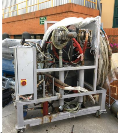
Figura 41. Máquina de inyección de aislante térmico conformada por una válvula de diafragma
