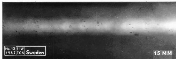
Figura 19. Radiografía de soldadura con porosidad
