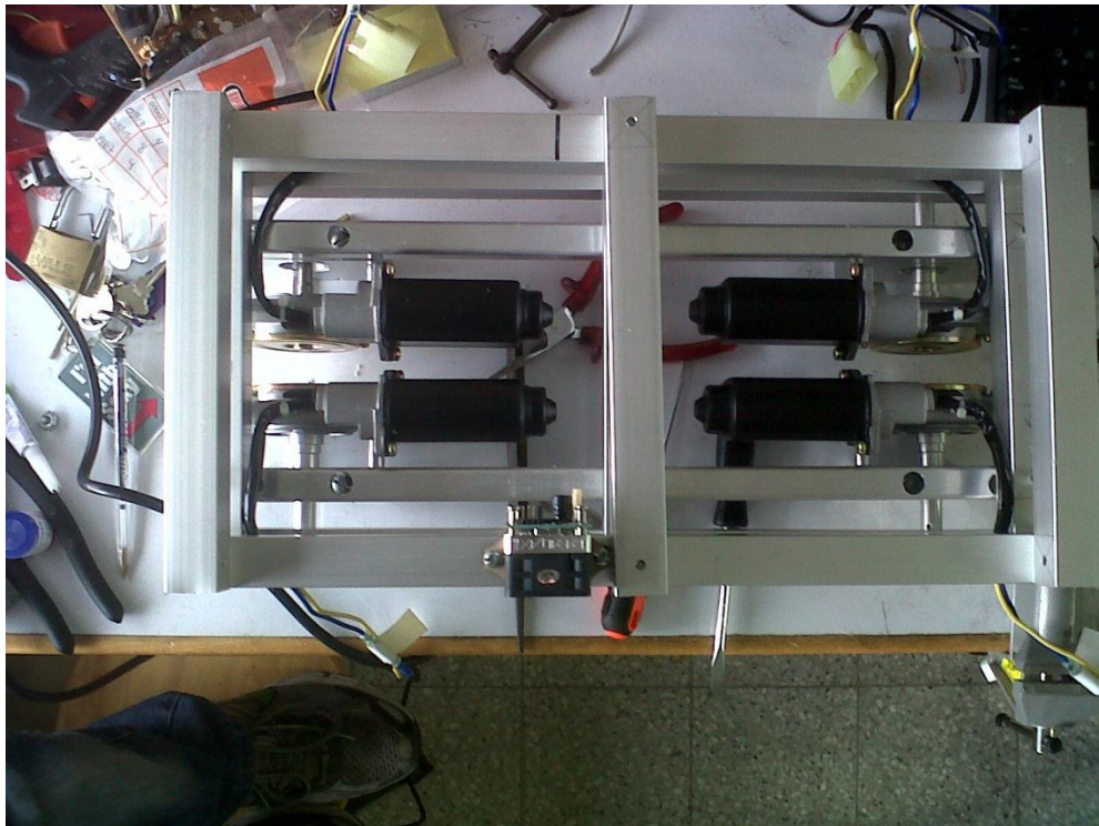
Figura 102. Instalación completa de motores
