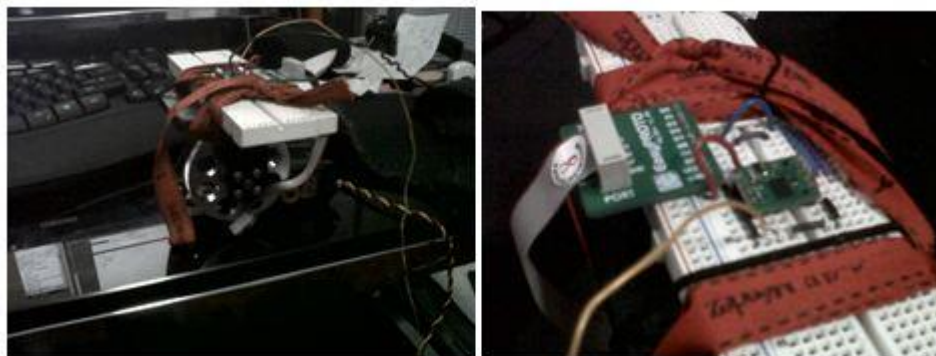
Figura 90. Implementación del sensor MMA7455 sobre el servomotor, para el inicio de pruebas
