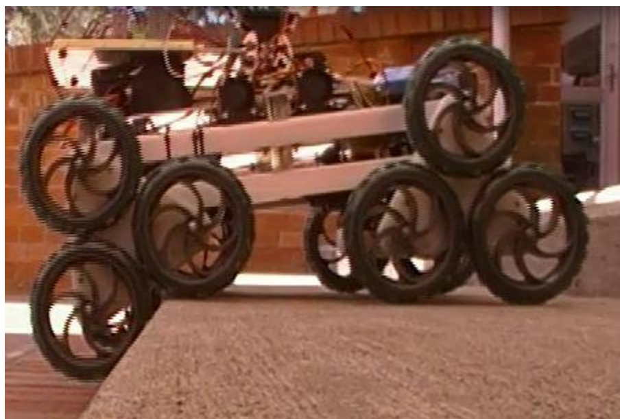
Figura 7. Prueba de descenso de gradas, final de secuencia de subida
