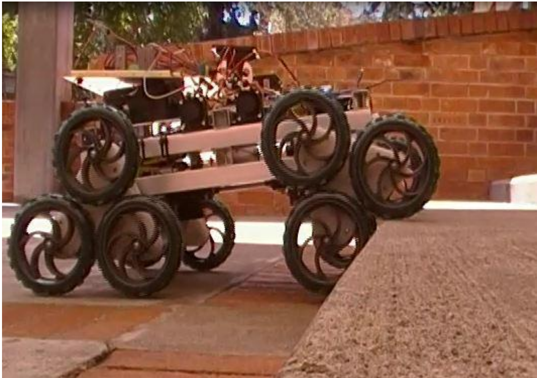
Figura 5. Prueba de ascenso de gradas, inicio de subida
