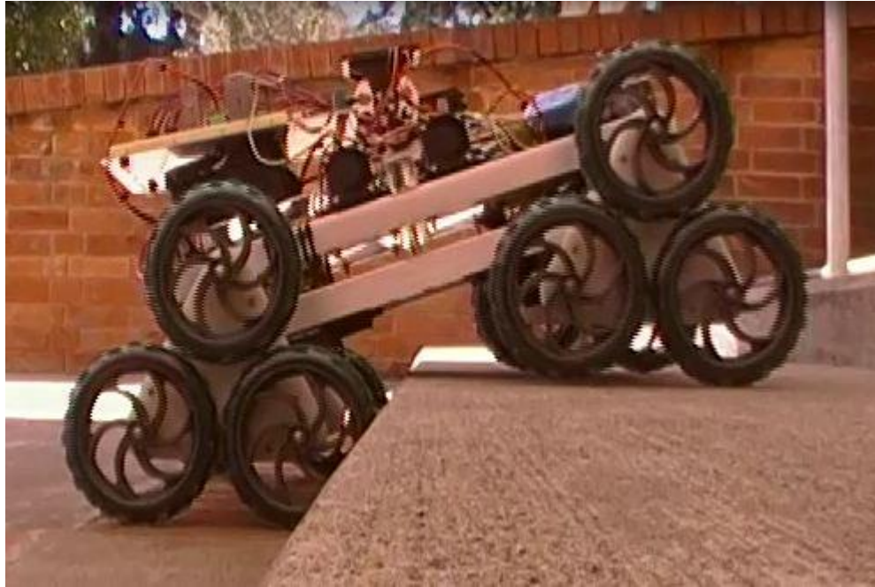
Figura 6. Prueba de descenso de gradas, mitad de la secuencia de subida
