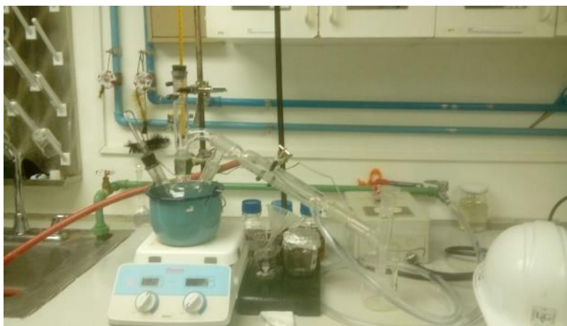
Figura 23: Sistema de destilación de solventes puesto en baño de arena. Departamento de Ingeniería Química, Laboratorio de Operaciones Unitarias, Universidad del Valle de Guatemala.
