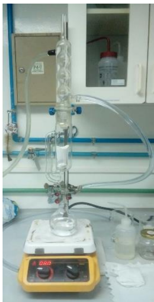
Figura 18: Sistema de extracción utilizado para la extracción de aceite de café. Departamento de Ingeniería Química, Laboratorio de Operaciones Unitarias, Universidad del Valle de Guatemala.
