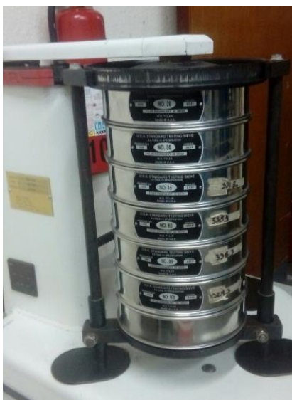
Figura 15: Tamizaje de poso de café secado, realizado en un banco de tamices. Departamento de Ingeniería Química, Laboratorio de Operaciones Unitarias, Universidad del Valle de Guatemala.
