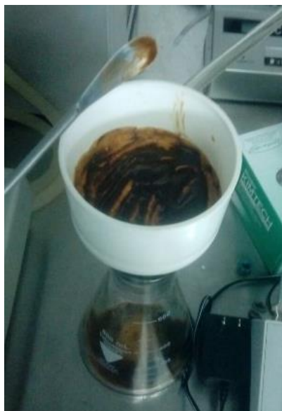
Figura 26: Filtración al vacío del aceite extraído. Departamento de Ingeniería Química, Laboratorio de Operaciones Unitarias, Universidad del Valle de Guatemala.
