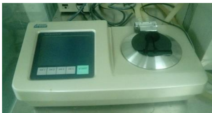
Figura 29: Refractómetro utilizado para pruebas del índice de refracción del aceite de café. Departamento de Ingeniería Química, Laboratorio de Operaciones Unitarias, Universidad del Valle de Guatemala.
