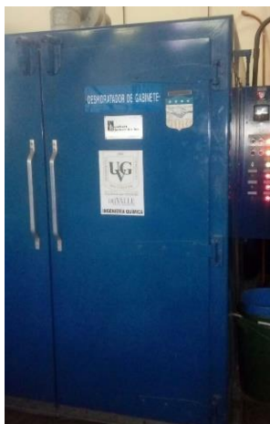
Figura 10: Secador de gabinete utilizado para secar el poso de café. Departamento de Ingeniería Química, Laboratorio de Operaciones Unitarias, Universidad del Valle de Guatemala.
