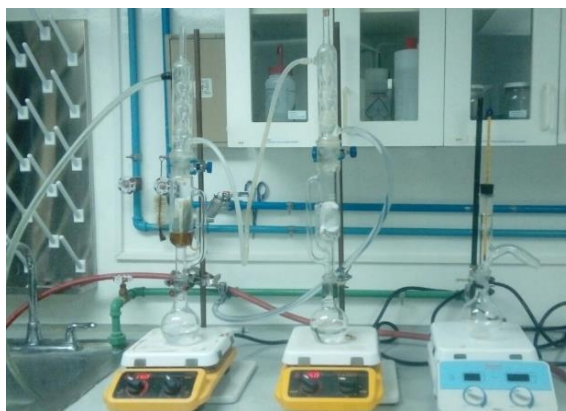
Figura 19: Dos sistemas de extracción puestos en serie. Departamento de Ingeniería Química, Laboratorio de Operaciones Unitarias, Universidad del Valle de Guatemala.
