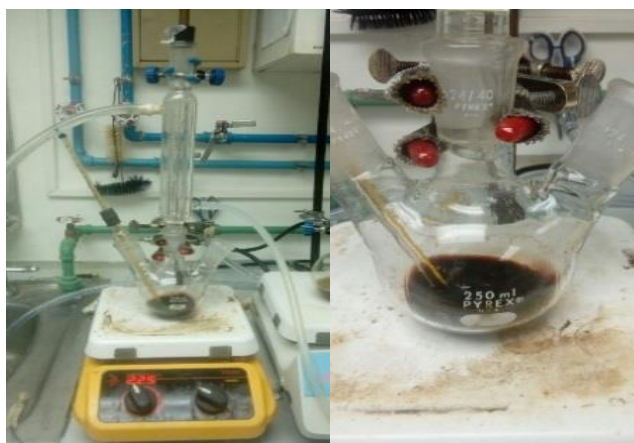
Figura 31: Reacción de esterificación en medio ácido realizada al aceite de café para la producción de biodiésel. Departamento de Ingeniería Química, Laboratorio de Operaciones Unitarias, Universidad del Valle de Guatemala.
