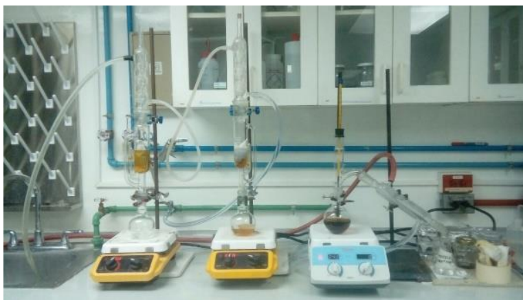
Figura 22: Sistemas de extracción de aceite de café y destilación de solventes, puestos en serie. Departamento de Ingeniería Química, Laboratorio de Operaciones Unitarias, Universidad del Valle de Guatemala.
