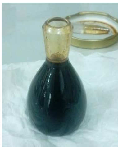
Figura 28: Prueba de densidad del aceite de café. Departamento de Ingeniería Química, Laboratorio de Operaciones Unitarias, Universidad del Valle de Guatemala.
