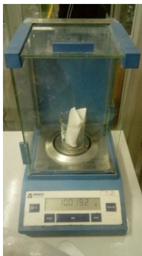
Figura 16: filtro o cartucho Soxhlet utilizado para realizar la extracción del aceite de café. Departamento de Ingeniería Química, Laboratorio de Operaciones Unitarias, Universidad del Valle de Guatemala.
