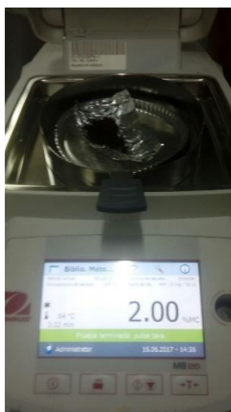
Figura 13: verificación de la humedad del poso de café en balanza de humedad. Departamento de Ingeniería Química, Laboratorio de Operaciones Unitarias, Universidad del Valle de Guatemala.
