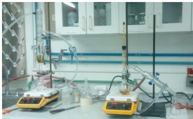
Figura 20: Sistema de extracción y destilación realizados al mismo tiempo. Departamento de Ingeniería Química, Laboratorio de Operaciones Unitarias, Universidad del Valle de Guatemala.
