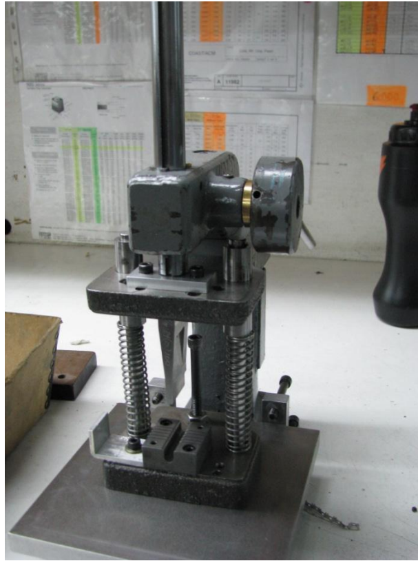
Figura 9: Operación de doblado manual
