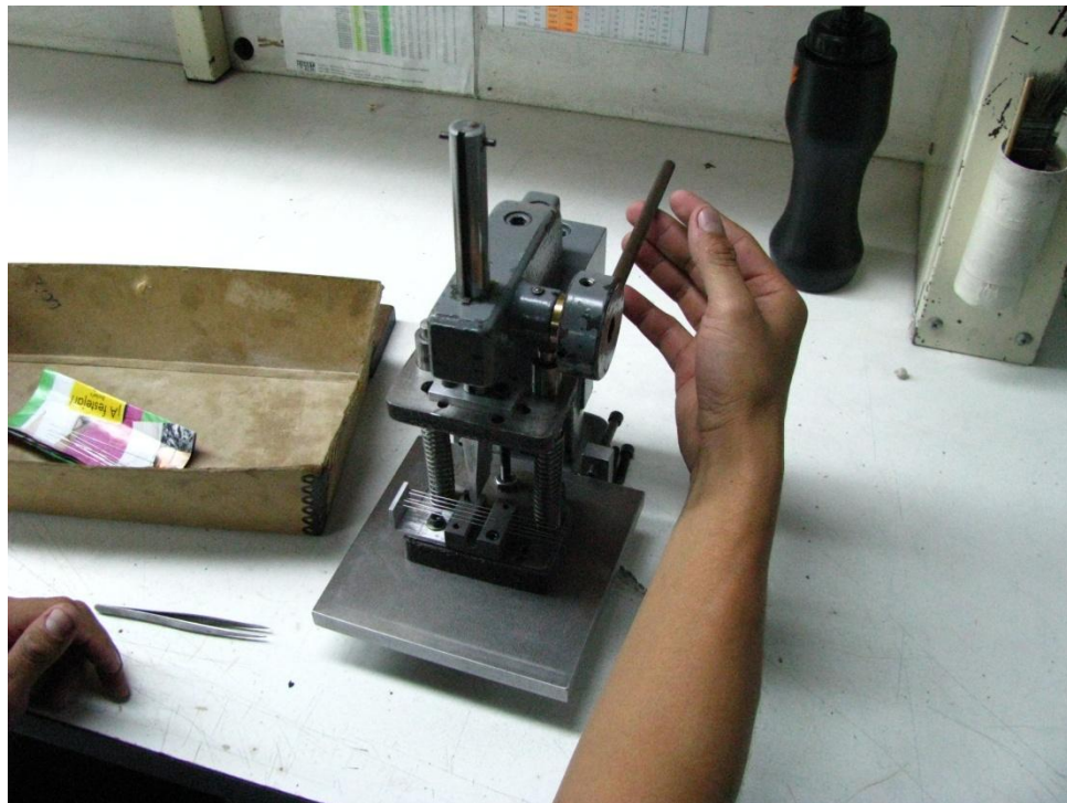
Figura 9: Operación de doblado manual
