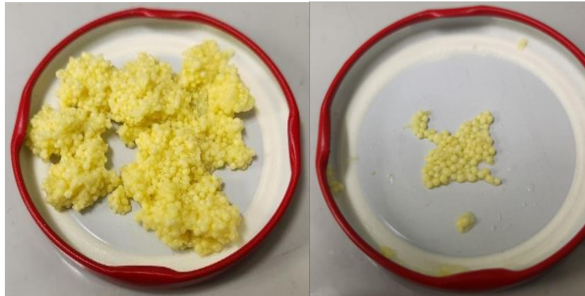
Figura 36 Microcápsulas de aceite esencial extraído obtenidas por microemulsión (sin liofilizar)
