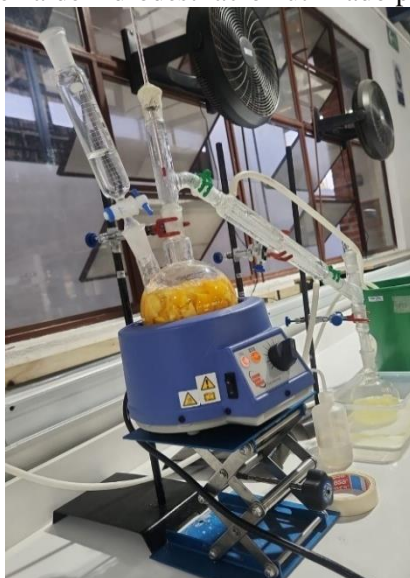
Figura 29 Montaje del sistema de hidrodestilación utilizado para extraer el aceite esencial
