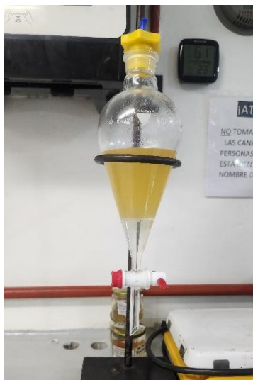
Figura 30 Montaje del sistema para extracción líquido-líquido del aceite con cloroformo
