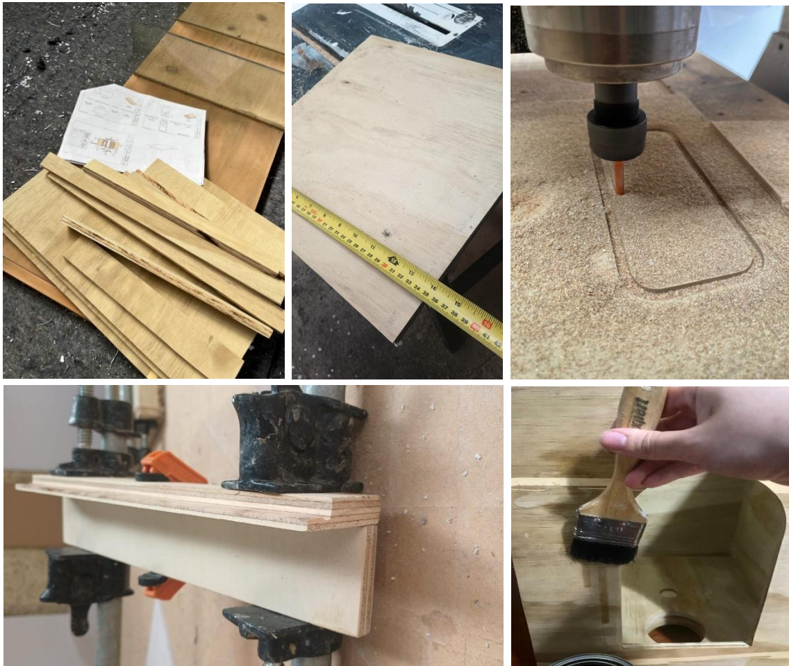
Figura 32. Fotografías del proceso de armado de la estructura de madera
