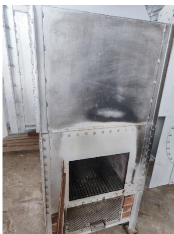
Figura 26. Caldera de horno tipo silo para el secado de macadamia
