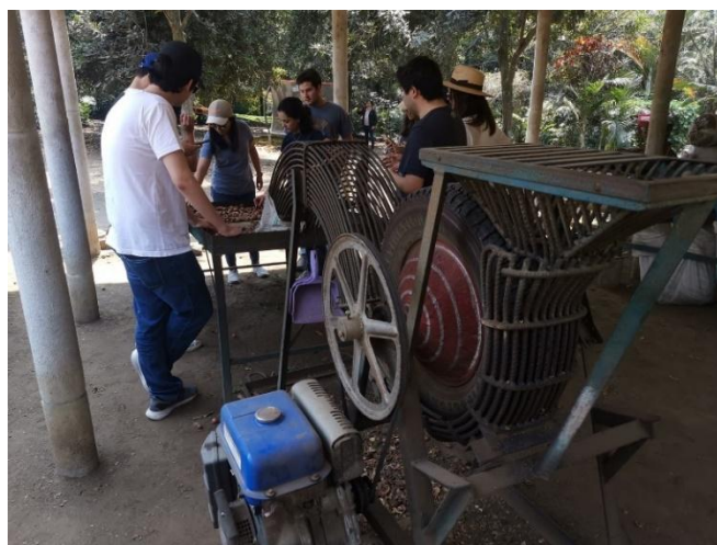
Figura 21. Máquina descascaradora de macadamia utilizada en finca Valhalla
