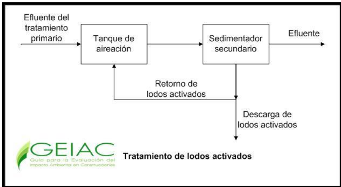
Ilustración 214. Tratamiento de lodos activados
