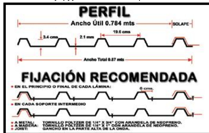
Ilustración 121. Perfil y fijación recomendada para lámina termoacústica.
