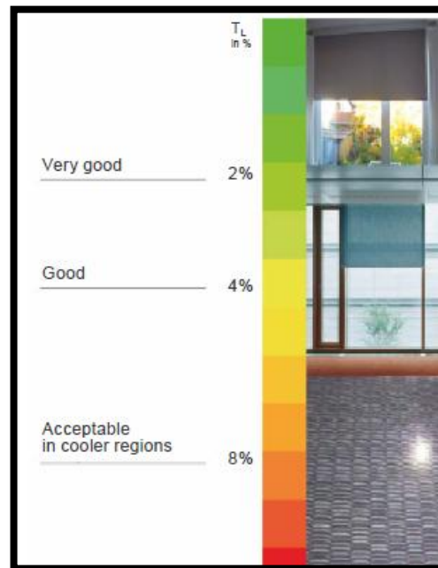
Ilustración 161. Parámetros de transmisión de luz.
