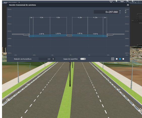
Figura 77. Sección correspondiente a una V1-Vía de Enlace
