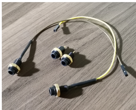
Figura 33: Adaptadores para electrodos de referencia
