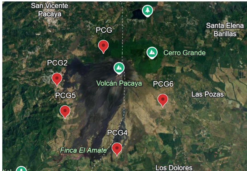
Figura 5.2: Red de estaciones sísmicas encargadas de monitorear el volcán de Pacaya
