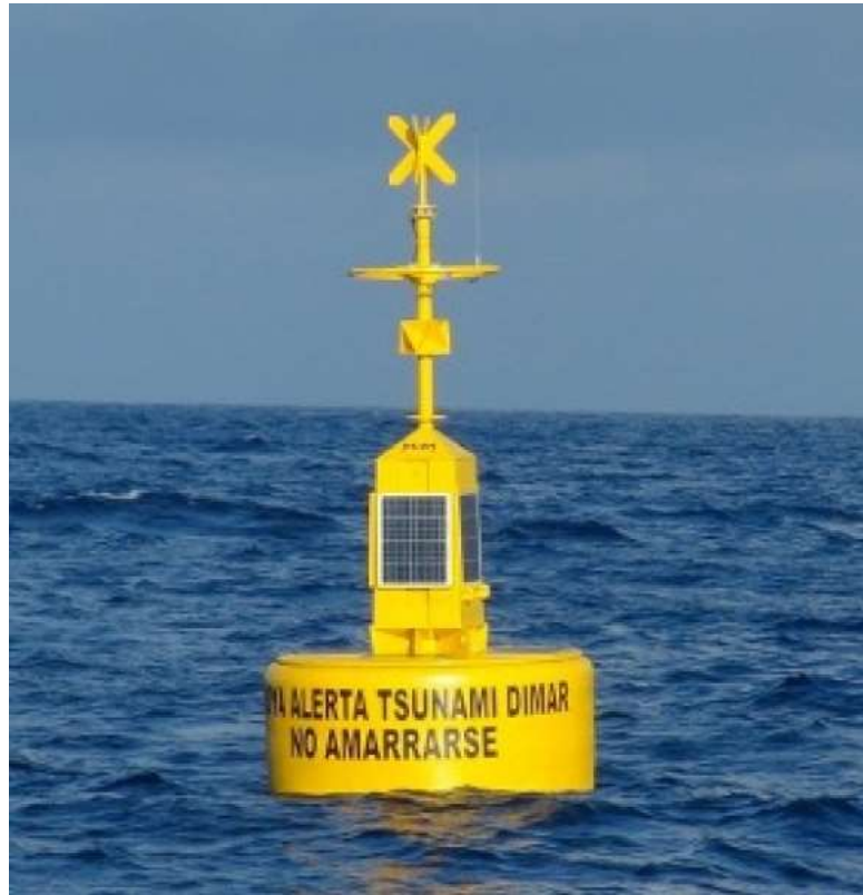
Ilustración 60. Boya de detección de tsunamis ubicada en las costas pacíficas de Colombia.
