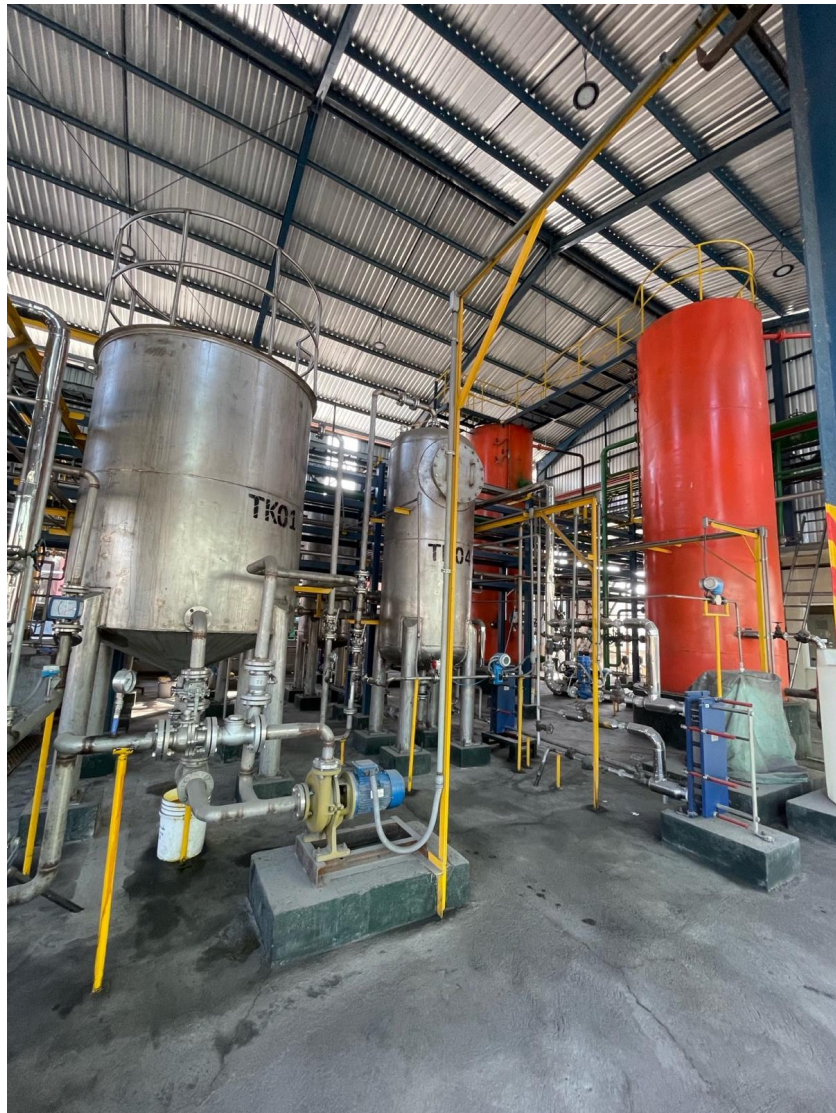
Figura 24: Planta de lavado de aceite crudo de palma.
