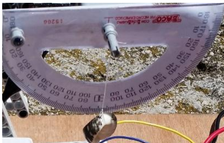
Figura 20. Forma de medición del ángulo de incidencia por medio de un transportador adherido a la superficie en donde se encuentran las celdas solares
