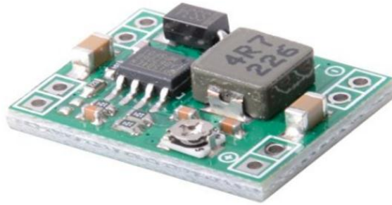
Figura 31 Regulador MP1584EN escogido para entregar voltajes de 3.3V y 5V
