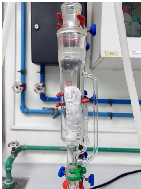
Figura 29. Colocación de la muestra pretratada en la cámara
