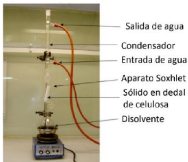
Figura 12. Equipo de extracción de Soxhlet
