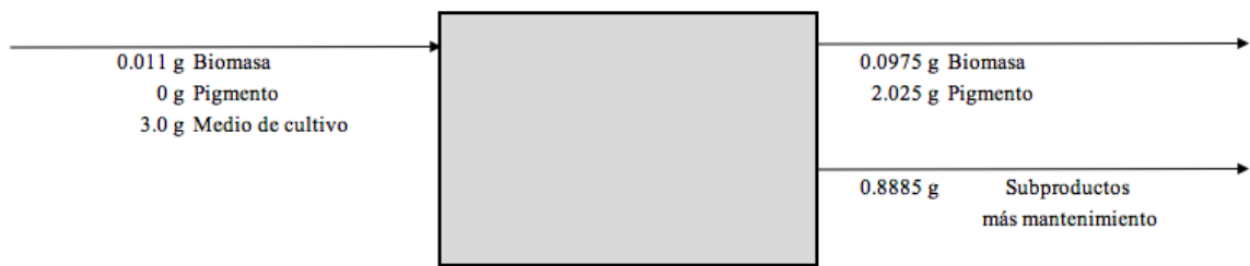
Figura 27: Balance de masa de la producción de pigmento a partir del microorganismo A en la formulación con la que se obtuvo mayor producción de pigmento.
