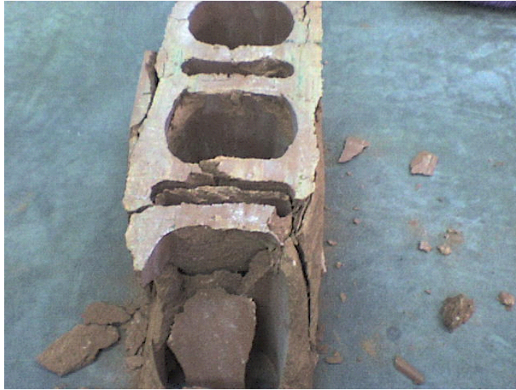
Gráfico No. 21 Fractura realizada por la fuerza aplicada al ladrillo
