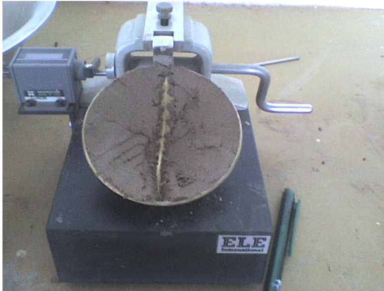
Gráfico No. 23 Surco realizado a la muestra de barro
