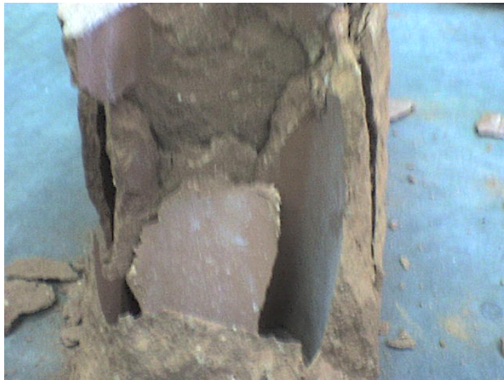
Gráfico No. 21 Fractura realizada por la fuerza aplicada al ladrillo
