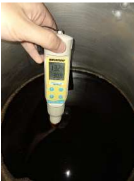
Figura 45. Determinación de pH de caldo de cocción obtenido del proceso de deslignificación
