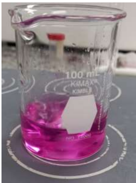
Figura 44. Resultado de reacción de oxidación de lignina con permanganato de potasio en medio ácido
