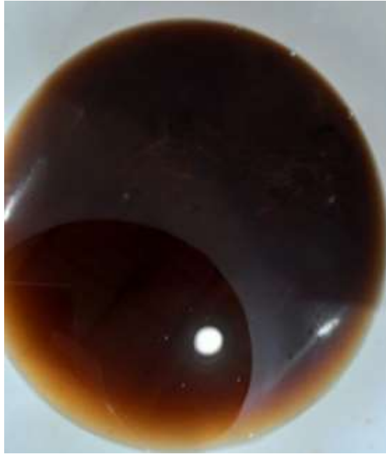
Figura 39. Licor de cocción obtenido después de proceso de deslignificación de pulpa
