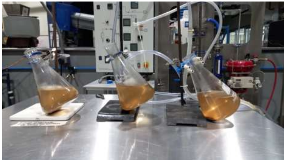
Figura 36. Desintegración de pulpa con ácido sulfúrico para determinación de porcentaje de Lignina Klason según método TAPPI-T222
