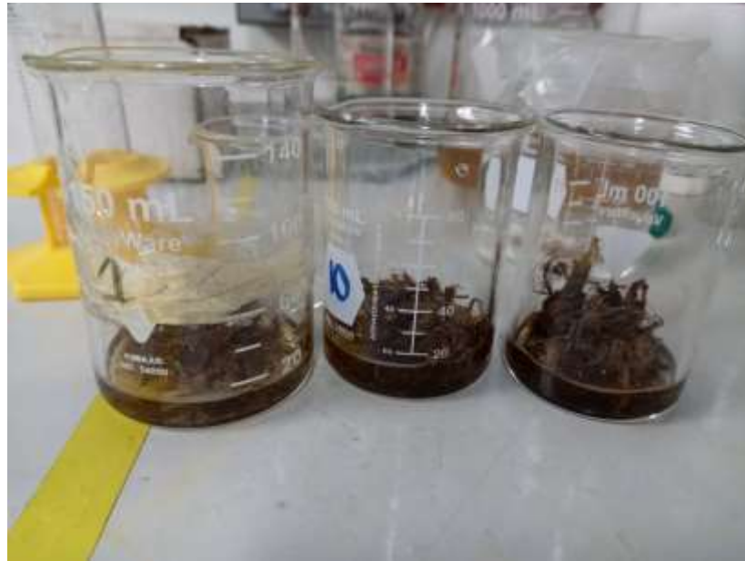
Figura 35. Desintegración de raquis de banana con Hidróxido de Sodio para determinación de \alpha -celulosa
