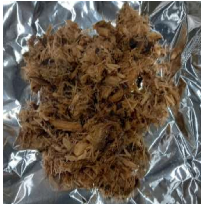
Figura 32. Trozos de raquis de banano triturado y prensado entregado por bananera
