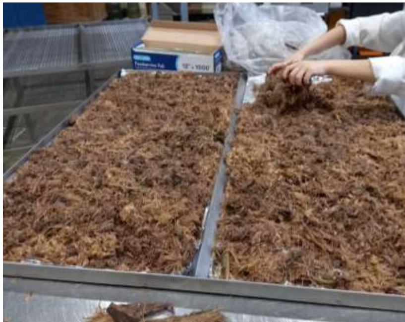
Figura 30. Raquis de banano triturado y prensado en bandejas para ingreso a secador industrial.
