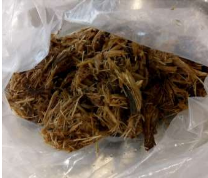
Figura 38. Pulpa resultante del proceso de cocción alcalina con Hidróxido de Sodio
