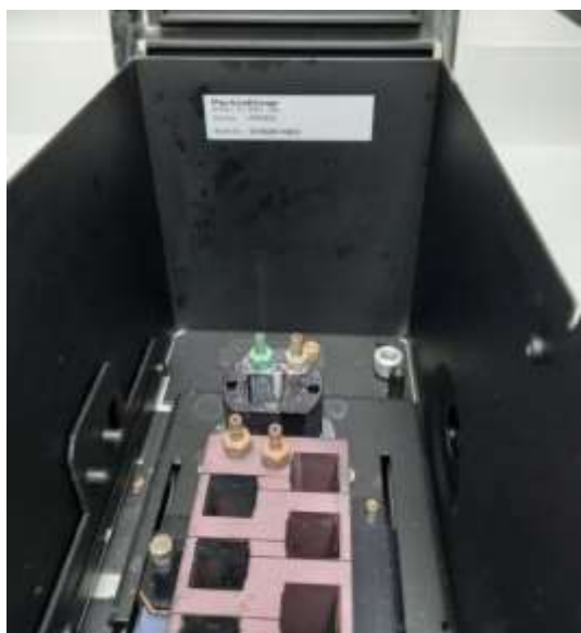
Figura 42. Espectrómetro utilizado durante determinación de número Kappa de deslignificación
