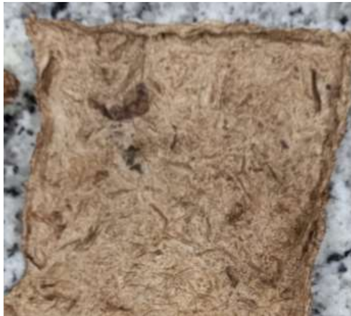
Figura 40. Pulpa seca después de proceso de deslignificación de raquis de banano
