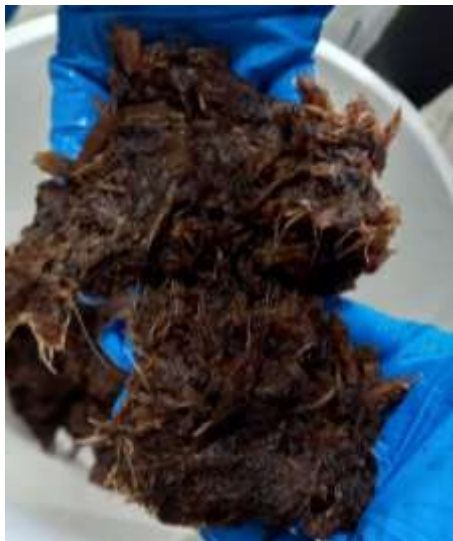
Figura 38. Pulpa resultante del proceso de cocción alcalina con Hidróxido de Sodio
