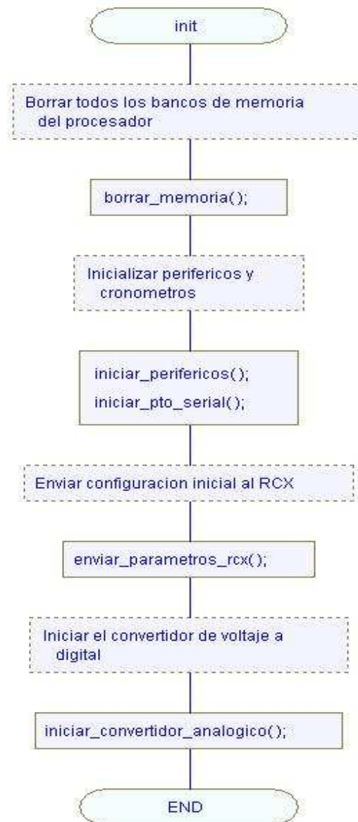
Figura 14: Algoritmo de inicio del programa para el sistema inmerso.
