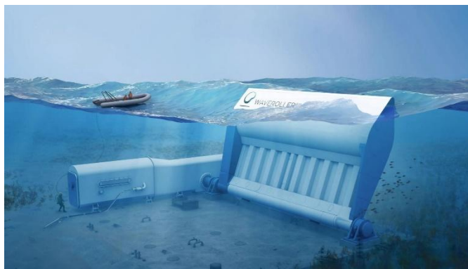
Figura 11: Representación de dispositivo WaveRoller sumergido
