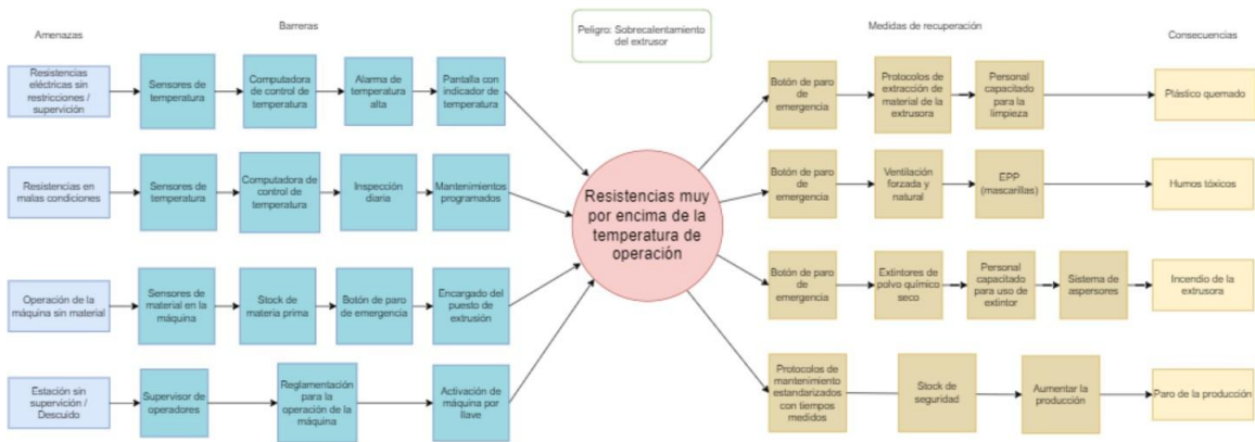
Figura 18 Análisis Bowtie para extrusora
