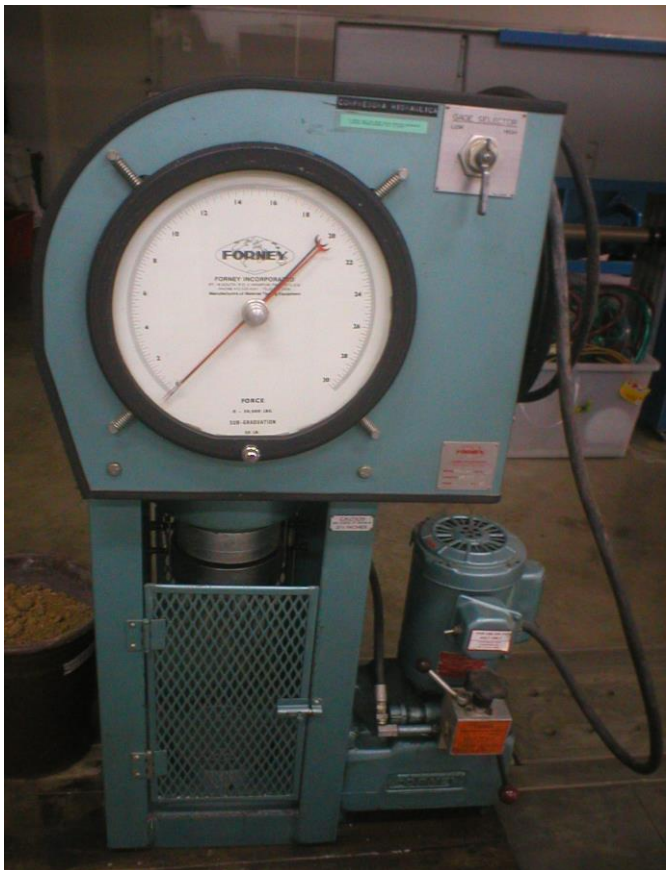
Foto 2. Compresora hidráulica Forney, FT-40-DR
