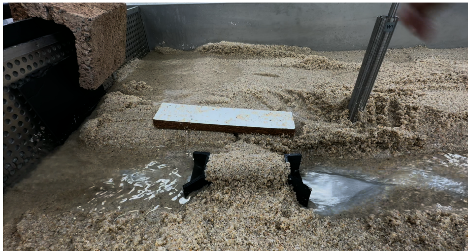
Figura 33. Pruebas de laboratorio Box Culvert de 1 celda
