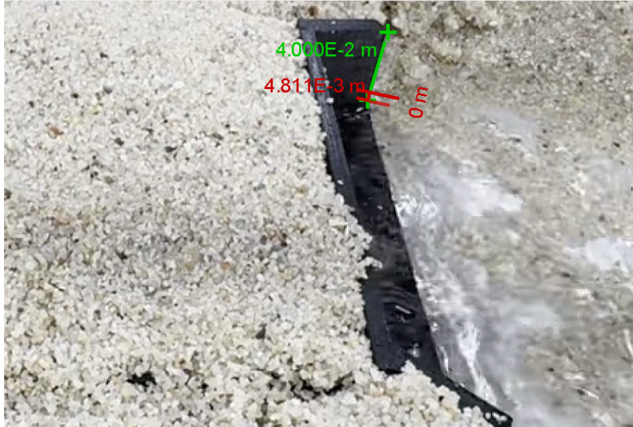
Figura 95. Box Culvert de 3 celdas, profundidad de salida, prueba 2 (Elaboración propia)
