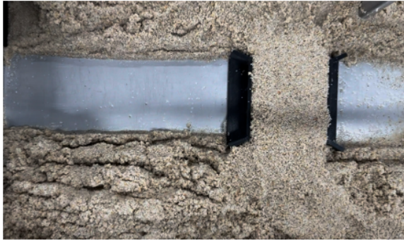
Figura 49. Arrastre de sedimentos, Box Culvert 3 celdas
