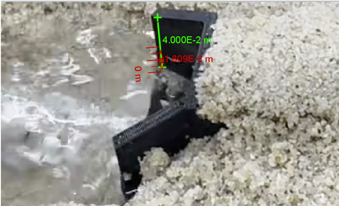
Figura 64. Box Culvert de 1 celda, profundidad de entrada, prueba 2
