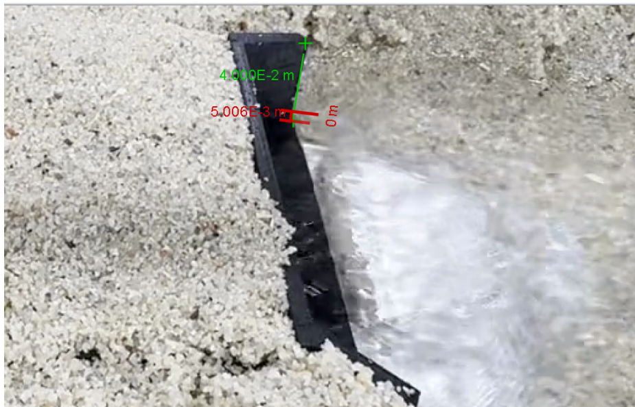
Figura 100. Box Culvert de 3 celdas, profundidad de salida, prueba 3 (Elaboración propia)
