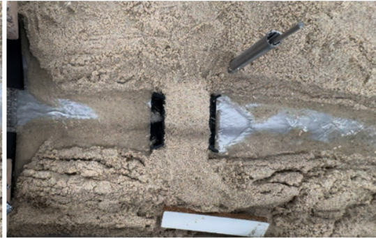
Figura 49. Arrastre de sedimentos, Box Culvert 3 celdas
