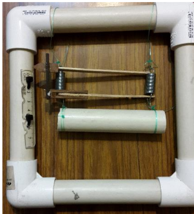
Figura 19. Dispositivo empleado para medir la fuerza ejercida por la mano.
