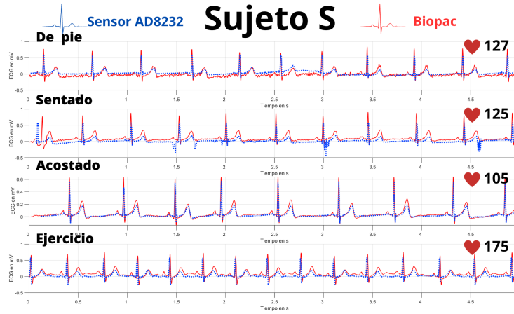
Figura 43: Comparativa electrocardiograma Biopac vs sensor AD8232 sujeto S.
