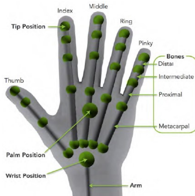
Figura 17: Estructura de la mano usada en el LEAP Motion [16].
