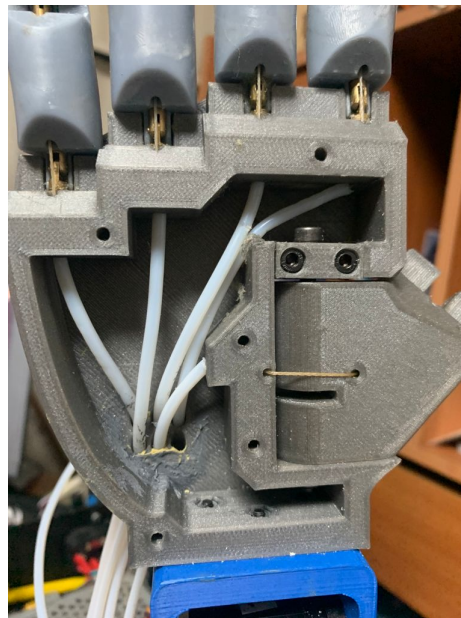
Figura 31: Estructura de la palma. Elaboración propia.
