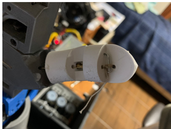
Figura 28: Prueba de amarre de hilos en falange distal. Elaboración propia.
