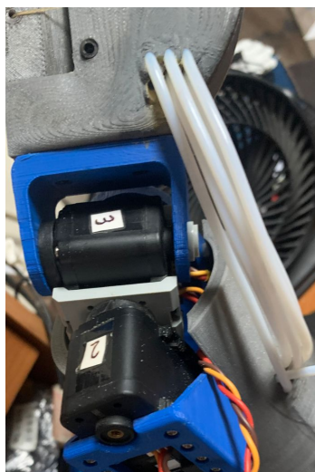
Figura 39: Tubos de teflón muy cortos. Elaboración propia.
