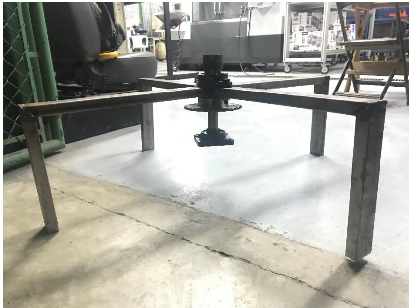
Ilustración 27 - Ensamble del eje y estructura de sujeción. Fuente: Fotografía propia
