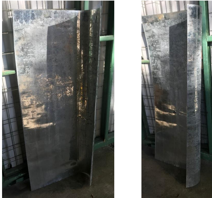
Ilustración 22 - Álabes. Fuente: Fotografía propia
