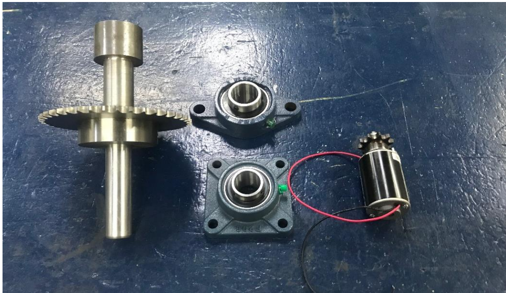
Ilustración 24 - Eje, sprocket, chumaceras, piñón y generador. Fuente: Fotografía propia
