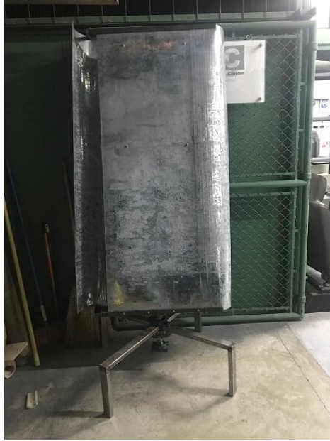
Ilustración 29 - Ensamblaje de los álabes y estructura. Fuente: Fotografía propia
