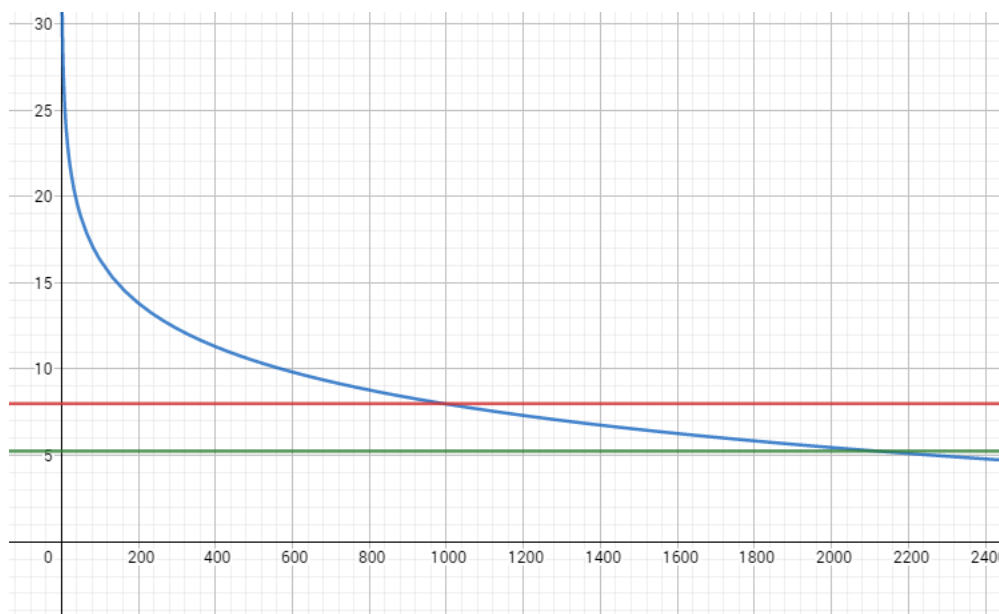
Figura 55. Rampa de descenso inicial de la refrigeradora y temperatura deseada, Temperatura (°C) – Tiempo (s).
