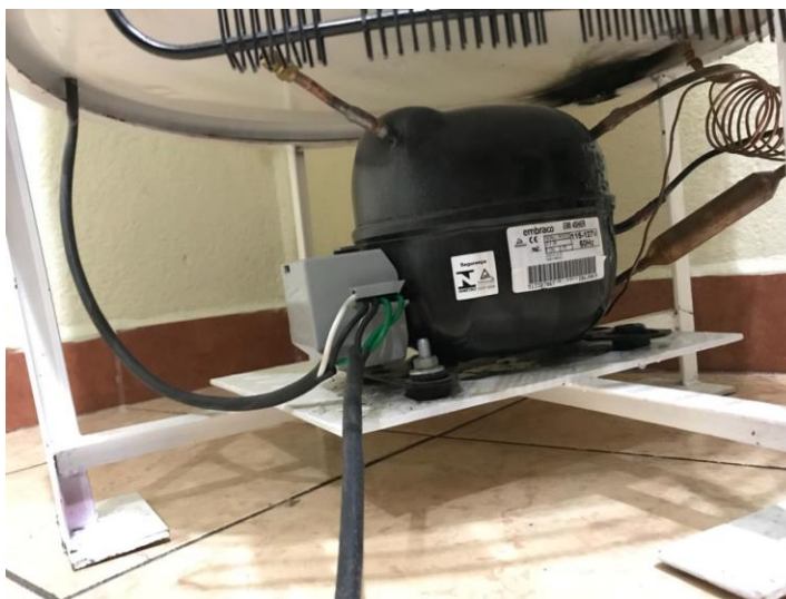
Figura 48. Compresor del prototipo, instalado en la refrigeradora.
