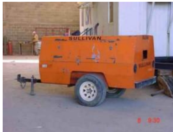
Figura 6. Compresores de aire
