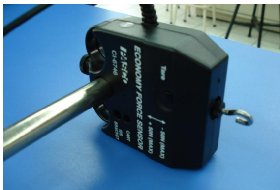
Figura 11. Sensor de Fuerza Pasco, colocado en la barra del soporte.
