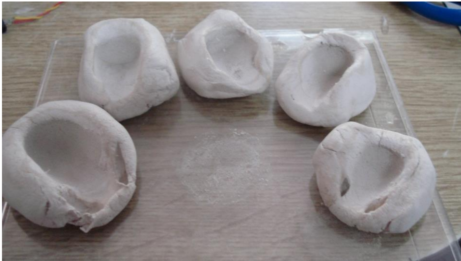
Figura 114. Moldes de masilla de las yemas de los dedos.
