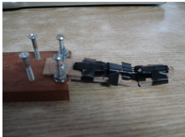
Figura 34. Modelo de dedo en Cartón con el Flexinol implementado.
