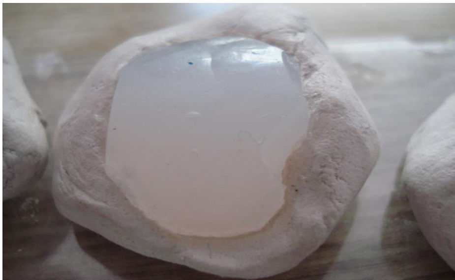
Figura 115. Silicón aplicado a un molde de una yema.
