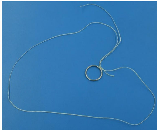
Figura 12. Hilo sujeto a la argolla, para poder halar la argolla del sensor de fuerza.
