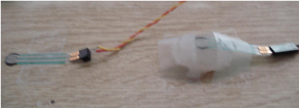
Figura 130. Sensores de fuerza FSR, (izquierda: control sensor FSR; derecha: prueba sensor en yema).
