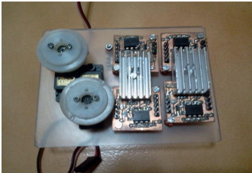
Figura 138. Placa del antebrazo con los servos y las placas PCB.
