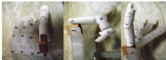
Figura 81. Prototipo del dedo índice acoplado a la mano de la prótesis original.
