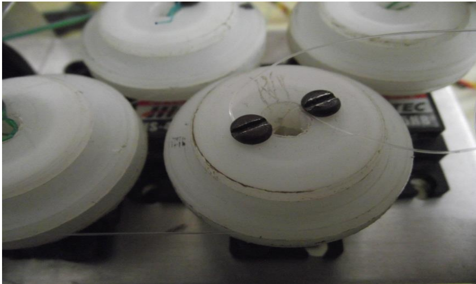
Figura 82. Sujeción de los hilos separadamente con la polea del servo motor.
