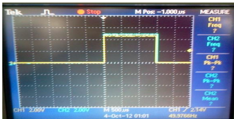
Figura 124. Comparando las señales de Entrada y Salida en tiempo de la señal PWM de la placa PCB para el funcionamiento del servo.
