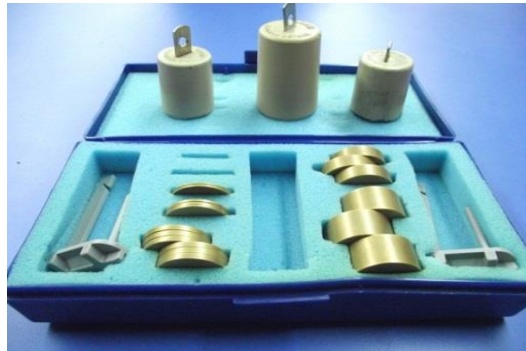
Figura 127. Pesos utilizados para la caracterización de los sensores de fuerza FSR.
