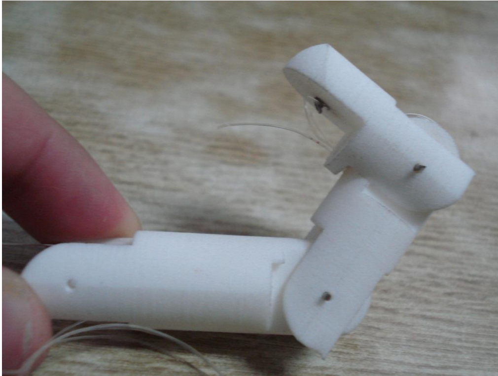
Figura 78. Modelo del dedo índice articulado vista trasera, maquinado en Nylon 6 mediante impresión en 3D.
