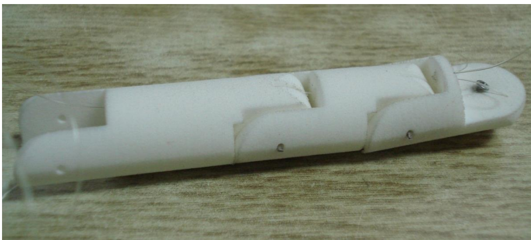
Figura 75. Modelo del dedo índice extendido, maquinado en Nylon 6 mediante impresión en 3D.
