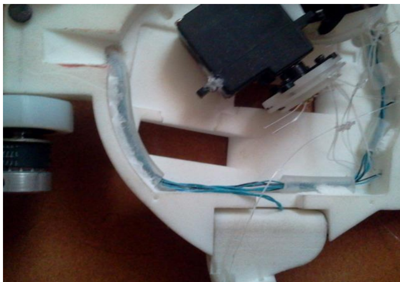
Figura 139. Cableado de sensores en el interior de la palma.
