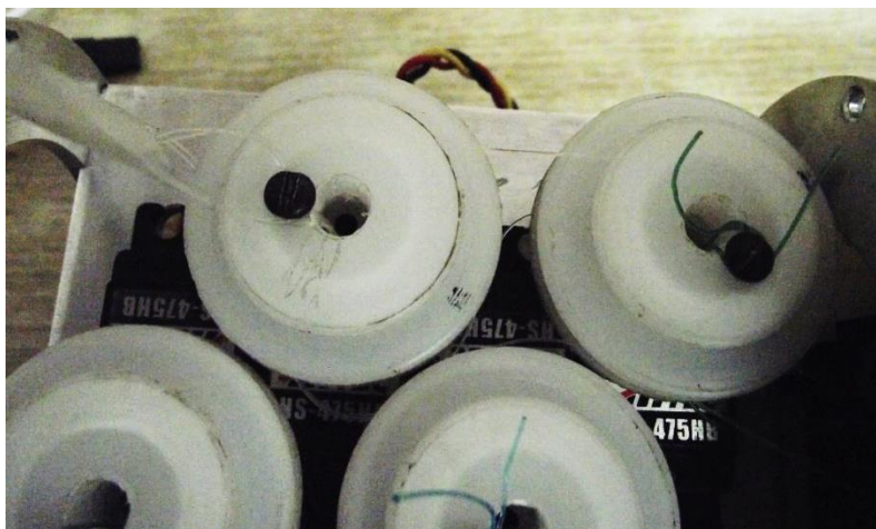
Figura 81. Sujeción de los hilos con la polea del servo motor.
