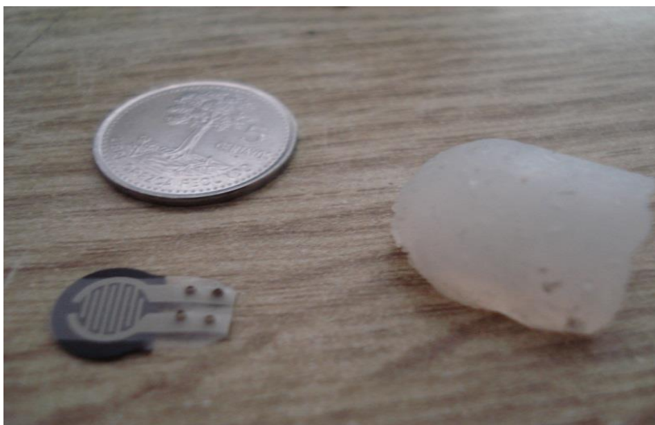
Figura 132. Sensor FSR recortado a la medida de la yema.
