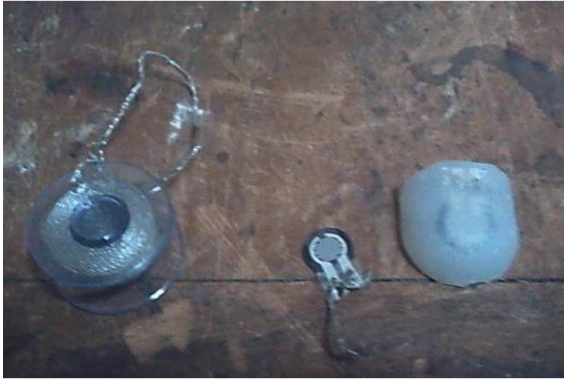
Figura 133. Hilo conductor, sensor con hilo conductor, yema con sensor.
