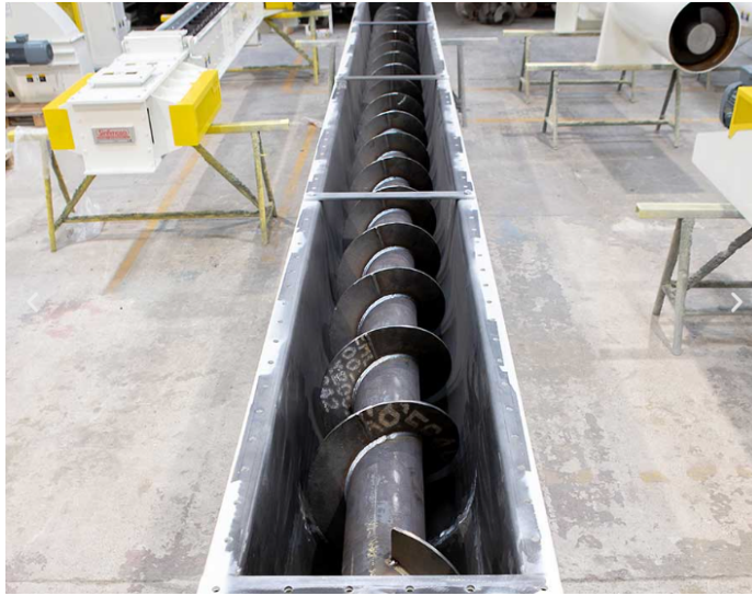
Figura 24: Módulo de tornillo sinfín utilizado en el sistema de lavado en caliente.
