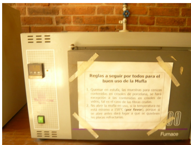
Fotografía No. 11 Mufla utilizada para la determinación de cenizas y fibra cruda
