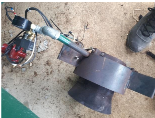
Ilustración 24 Quemador artesanal de gas para secadora de 70 quintales
