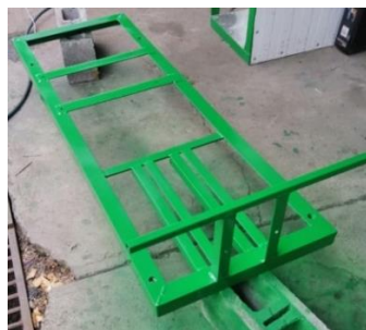
Ilustración 89 Estructura de unidad de potencia pintada
