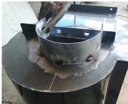
Ilustración 80 Puntos de soldadura en sección circular
