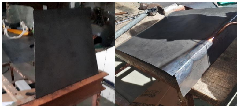
Ilustración 90 Doblado de lamina para elaboración de difusor
