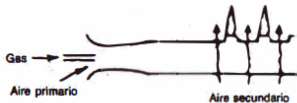
Ilustración 6 Quemador de premezclado con inyector
