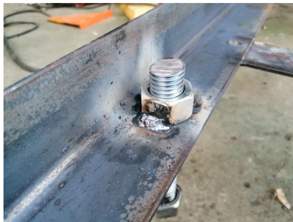
Ilustración 88 Mecanismo de nivelación de estructura soldado
