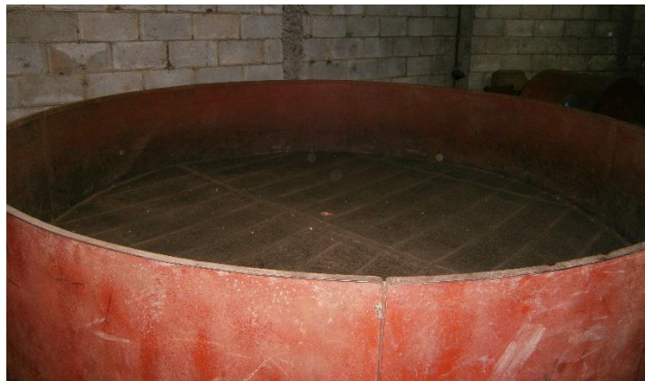
Ilustración 18 Secador cilíndrico en Senahú, Alta Verapaz
