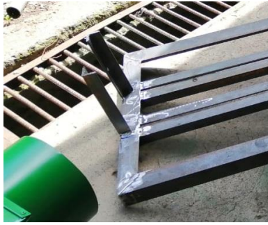
Ilustración 87 Perfiles de mecanismo de tensión sujetos al marco principal
