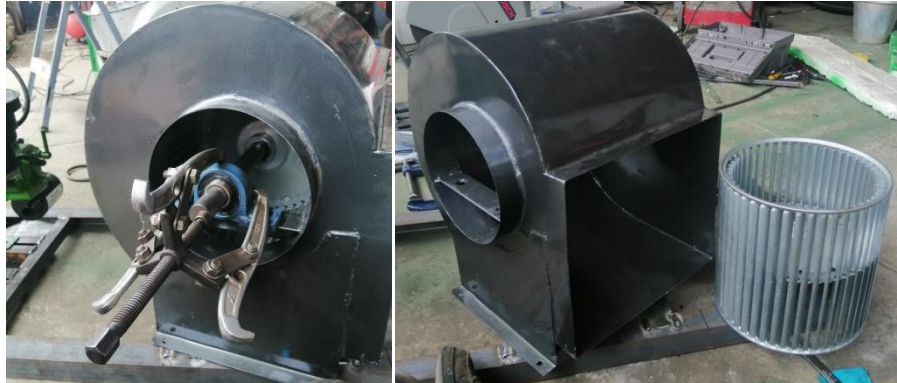
Ilustración 74 Desmontaje de elementos del ventilador
