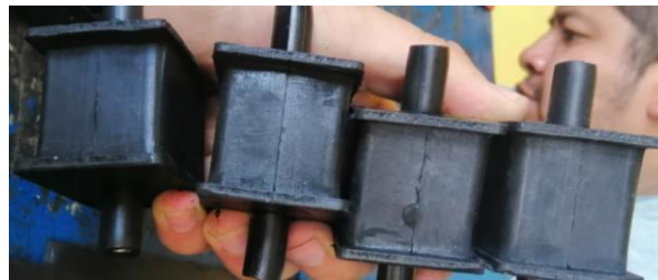
Ilustración 73 Amortiguadores de caucho empleados
