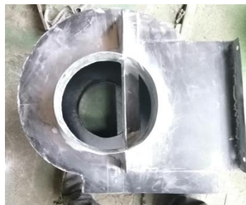
Ilustración 81 Soldadura de sección circular a nueva entrada de voluta
