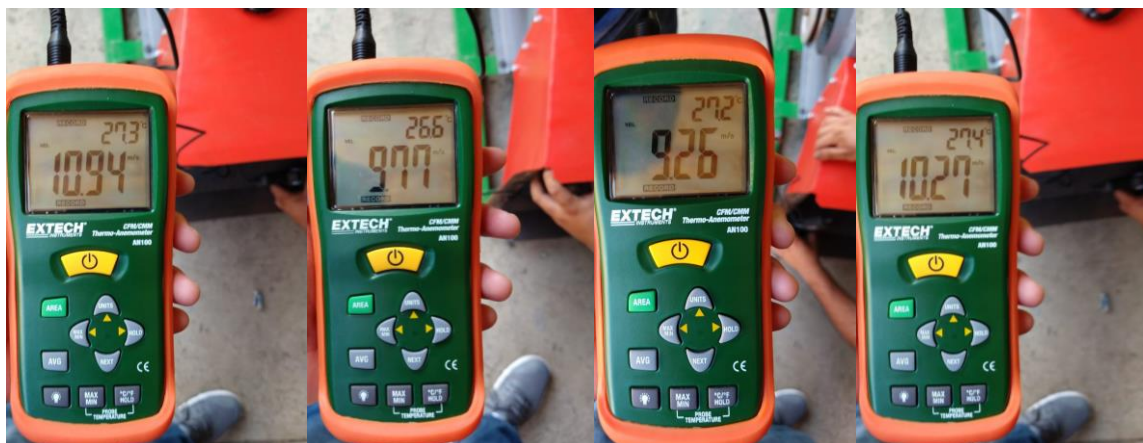
Ilustración 120 Lecturas del anemómetro en la salida de difusor
