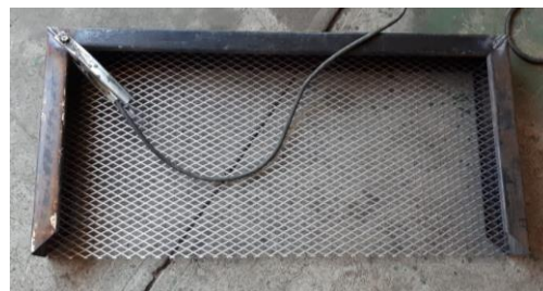
Ilustración 97 Malla colocada en su sitio para soldadura
