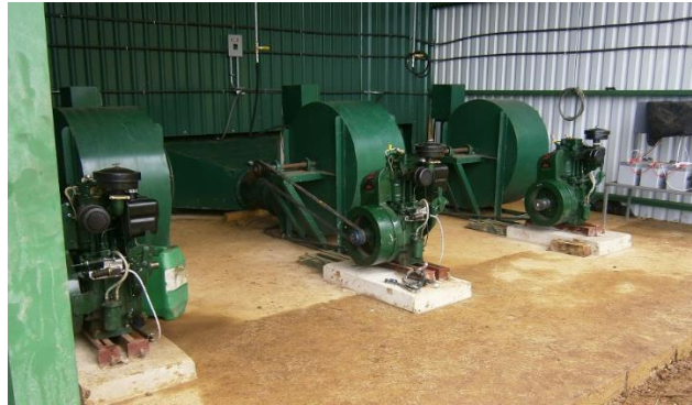
Ilustración 22 Unidades de ventilación de secadores en Senahú, Alta Verapaz
