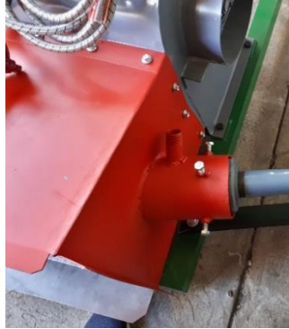
Ilustración 95 Difusor completo acoplado al quemador
