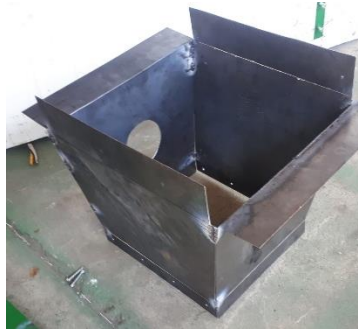
Ilustración 92 Geometría de difusor cerrada
