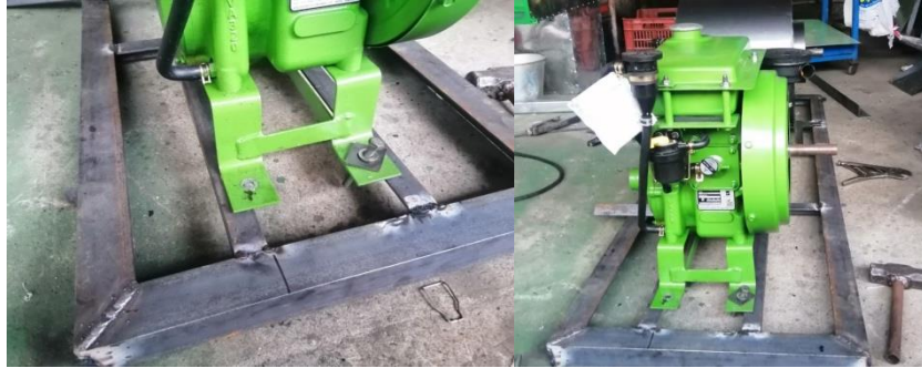
Ilustración 85 Posicionamiento del motor en la estructura
