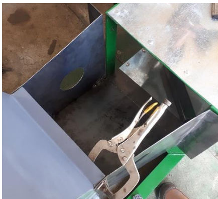
Ilustración 91 Ensamblaje de laminas del difusor sobre el sistema
