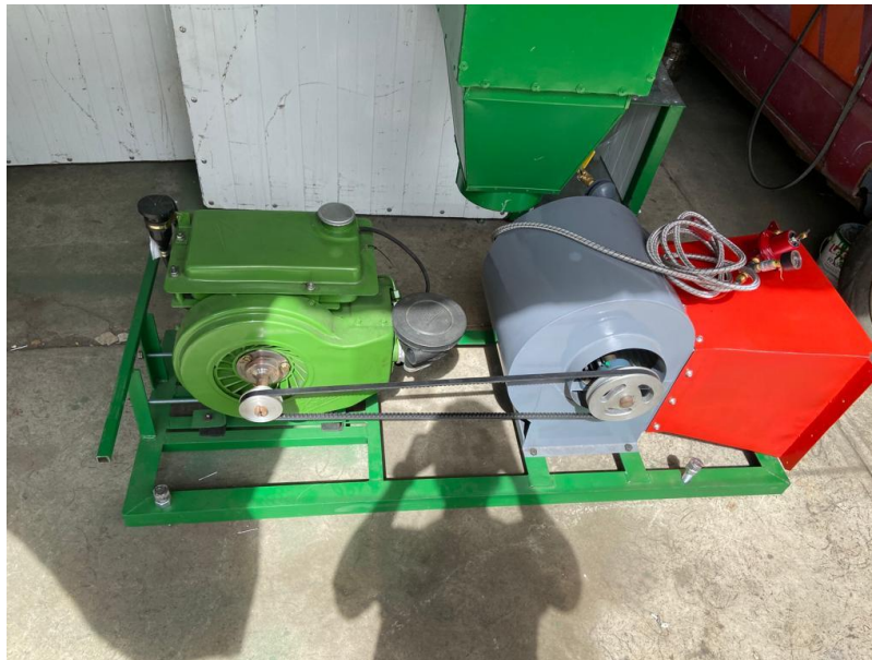
Ilustración 117: Módulo de potencia correctamente acoplado
