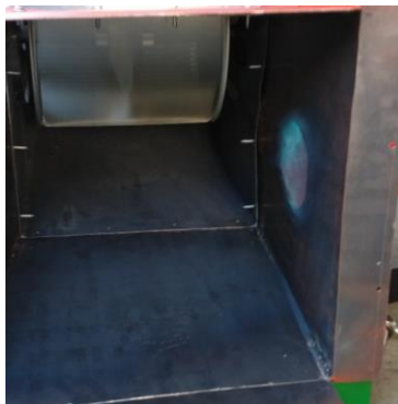
Ilustración 124 Llama del quemador expuesta al flujo de aire
