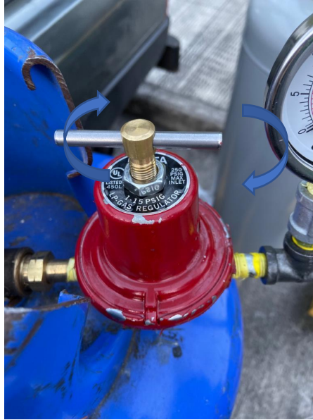
Imagen 3. Para subir la temperatura se mueve en sentido horario.
