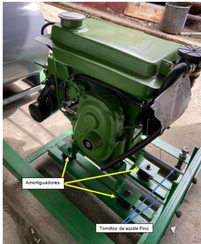
Ilustración 118: Motor aislado de vibraciones y tornillos de ajuste fino
