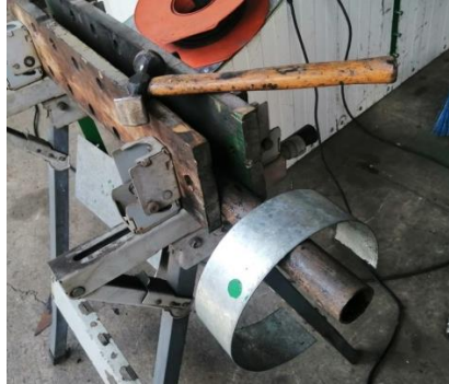
Ilustración 79 Doblado de chapa metálica
