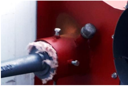
Ilustración 125 Coloración de superficie cercana al quemador
