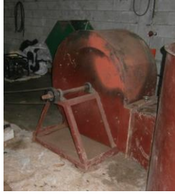
Ilustración 21 Ventilador centrífugo de secador en Senahú, Alta Verapaz
