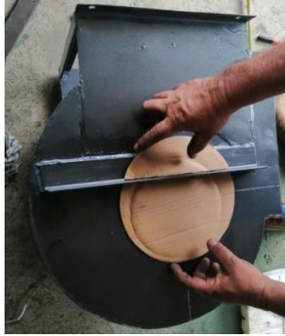
Ilustración 76 Posicionamiento de la referencia en cara cerrada de la voluta
