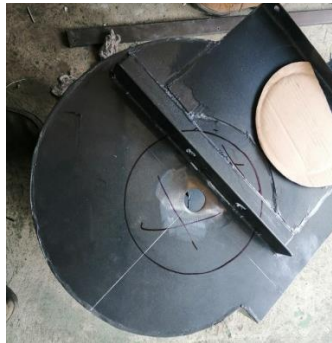
Ilustración 77 Trazo de la referencia sobre la superficie de corte
