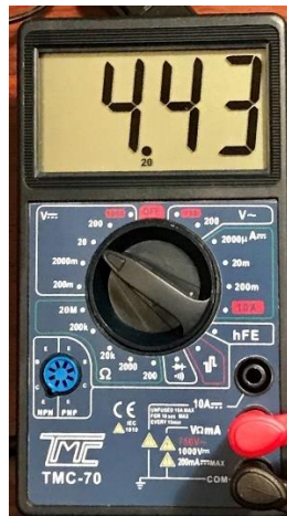
Figura 88. Medición de voltaje de la Raspberry Pi con multímetro.
