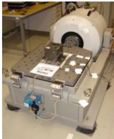
Figura 35. Pruebas de vibraciones a sistema integrado.
