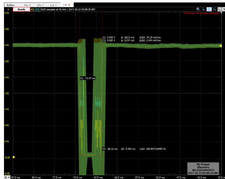
Figura 121. Medición de una lectura del bus con escala de tiempo de 5 ms.
