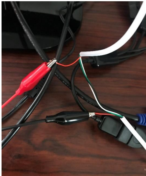
Figura 64. Método para medir corriente eléctrica.
