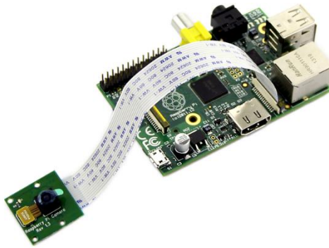
Figura 96. Conexión de módulo de cámara a la Raspberry.
