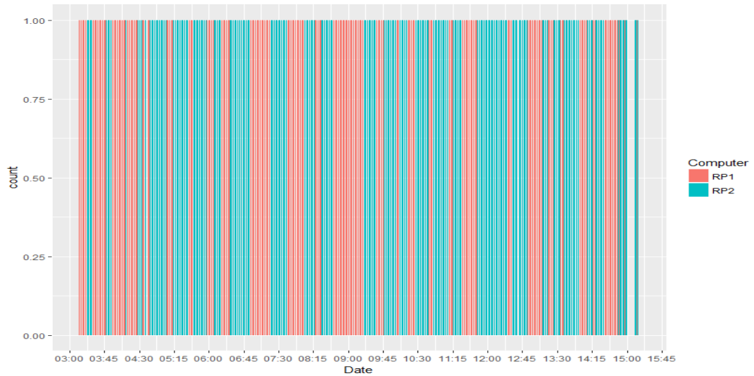
Figura 134. Funcionamiento de redundancia en las primeras doce horas.
