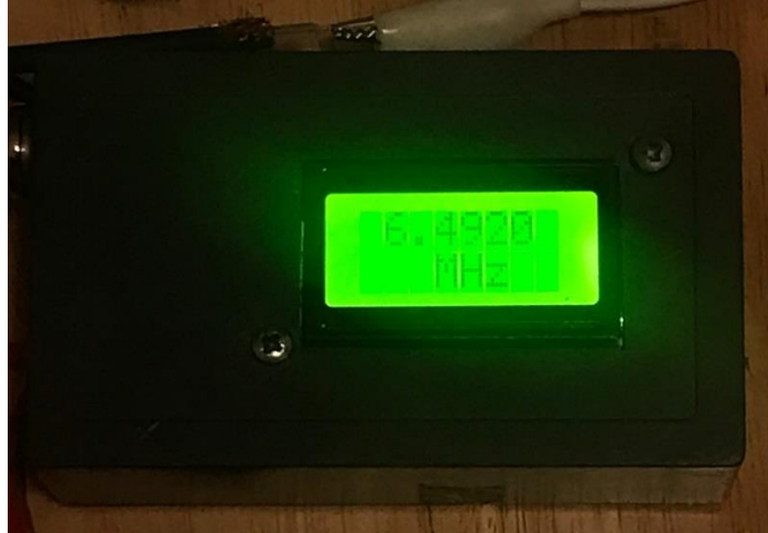
Figura 91. Frecuencia de los pulsos eléctricos para la prueba de interferencia electromagnética.
