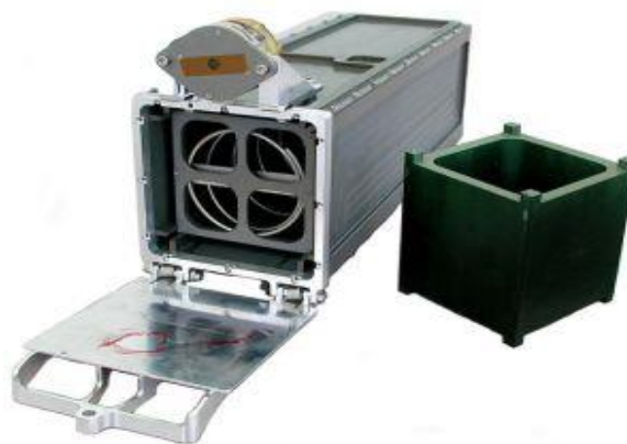
Figura 1. Sistema de despliegue utilizado para poner en órbita a los CubeSats en el espacio.
