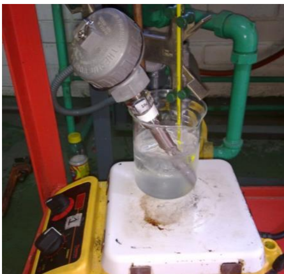
Figura 64: Sensor de temperatura comparado con termómetro
