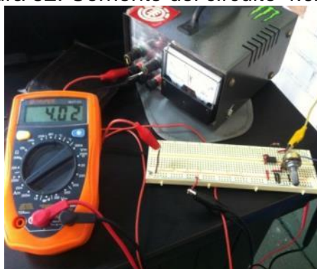
Figura 52: Corriente del circuito 4.02 mA
